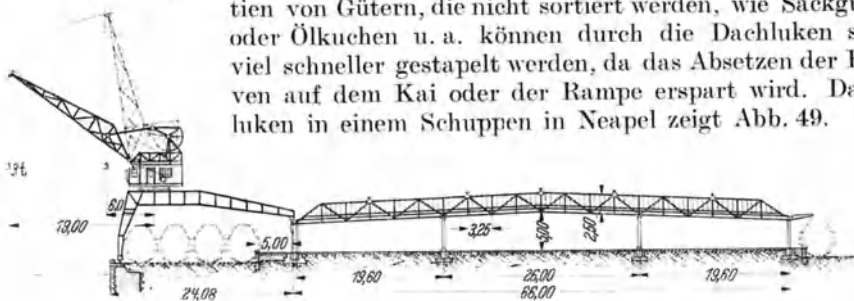
Abb. 39. Kaischuppen in Stahlkonstruktion.
