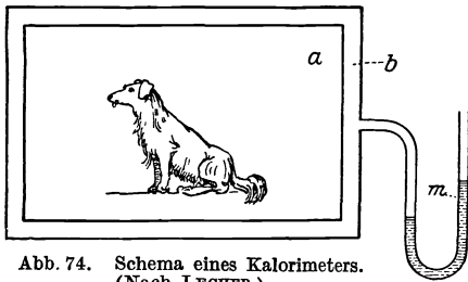
Abb. 74. Schema eines Kalorimeters. (Nach LECHER.)
