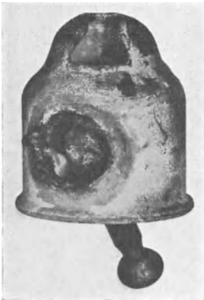
Abb. 14/4. Kopf eines Hängeisolators, von Durchschlag mit Lichtbogen im Betriebe zerstört (15000 V-Netz, 2 Glieder in Reihe).
