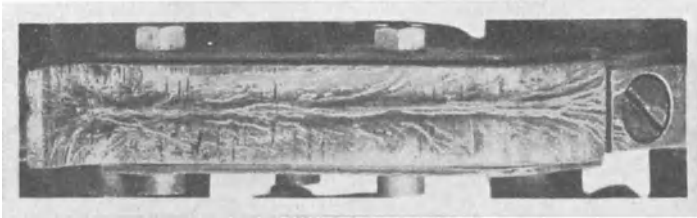
Abb. 86/4. Ablaufhorn eines Gleichstromschalters mit Lichtbogenspuren (Kathode).
