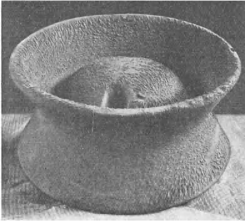
Abb. 56/6. Glied einer Hängeisolatorenkette, im Betrieb mit Zementstaub beschlagen (SSW).
