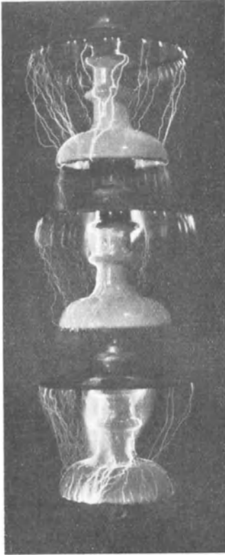
Abb. 56/5. Isolator 110 kV Betriebsspannung unter Regen, Spannung wenig unter Überschlagsspannung (BBC).
