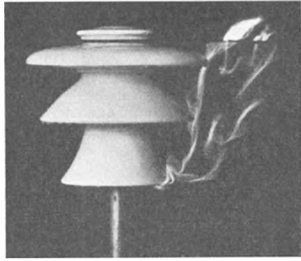
Abb. 56/2. Stützisolator für Freiluft (Weitschirmtype) bei 3 mm/min Regen unter 45° und Überschlag (bei 145 kV). (Hermisdorf.)
