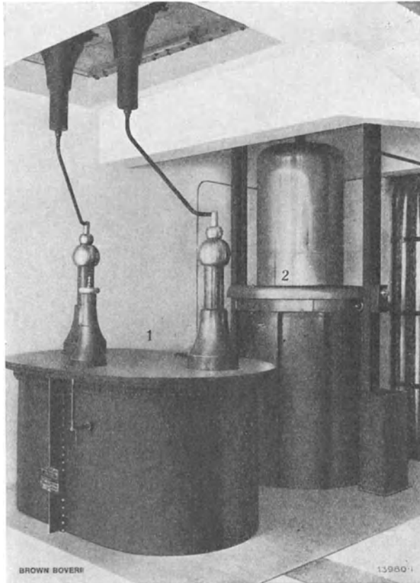
Abb. 82/5. Verlustloser, regelbarer Kondensator (2) bis 100 \sqrt{2} kV (mit Prüftransformator) (BBC).
