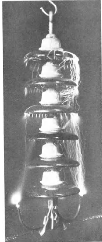
Abb. 60/5. Hängeisolator, Kappen- und Bolzentype, Regenüberschlag.
