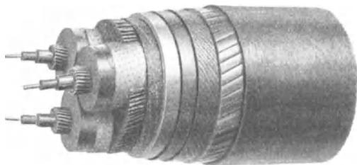
Abb. 108/5. Glimm- und strahlungsfreie Höchstspannungskabel, als Mehrleiterkabel bis 66 000 Volt, als Einleiterkabel bis 110 000 Volt (SSW).
