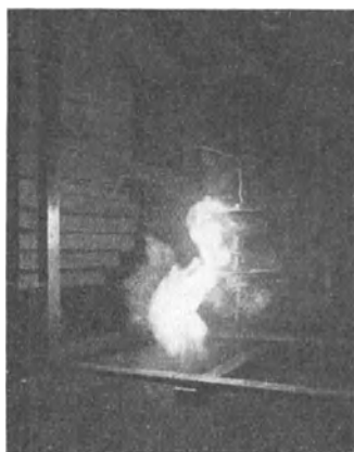
Abb. 90/1. Isolator mit Lichtbogen 120 A im Prüffeld (BBC).
