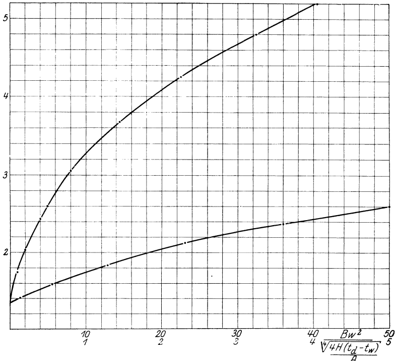
Abb. 121. Zur Berechnung der Wärmeübergangszahl für kondensierenden Wasserdampf.
