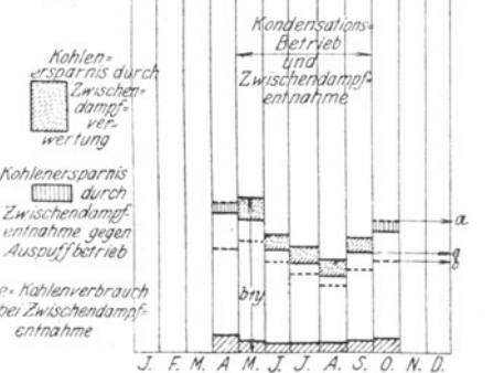
Kraft- und Heizdiagramm einer Maschinenfabrik bei Zwischendampfentnahme.
