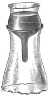
Abb. 23. Kolben mit birnenförmigem Verschuß, welcher durch Zuschmelzen eines Trichterrohres hergerichtet worden ist.
