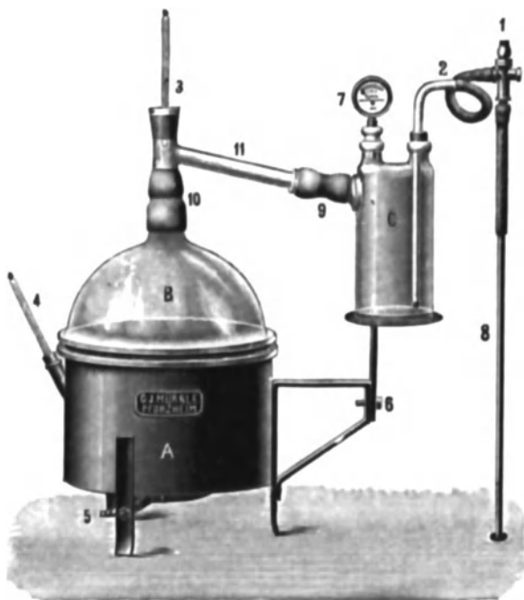
Abb. 1. Kleiner Vakuumapparat mit Gasheizung und Wasserstrahlluftpumpe.
