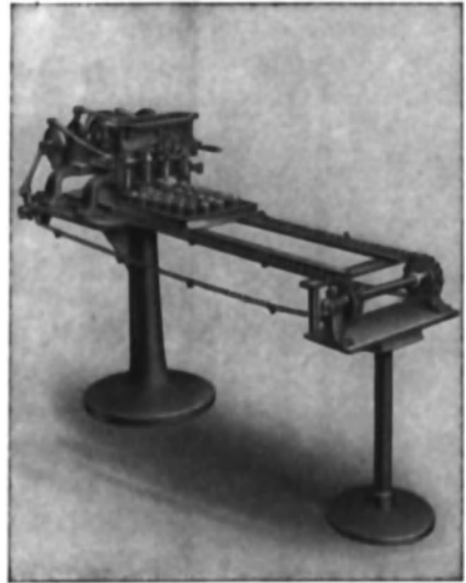
Abb. 12. Abfüllmaschine mit Einrichtung zum selbsttätigen Zu- und Abführen der Dosen.
