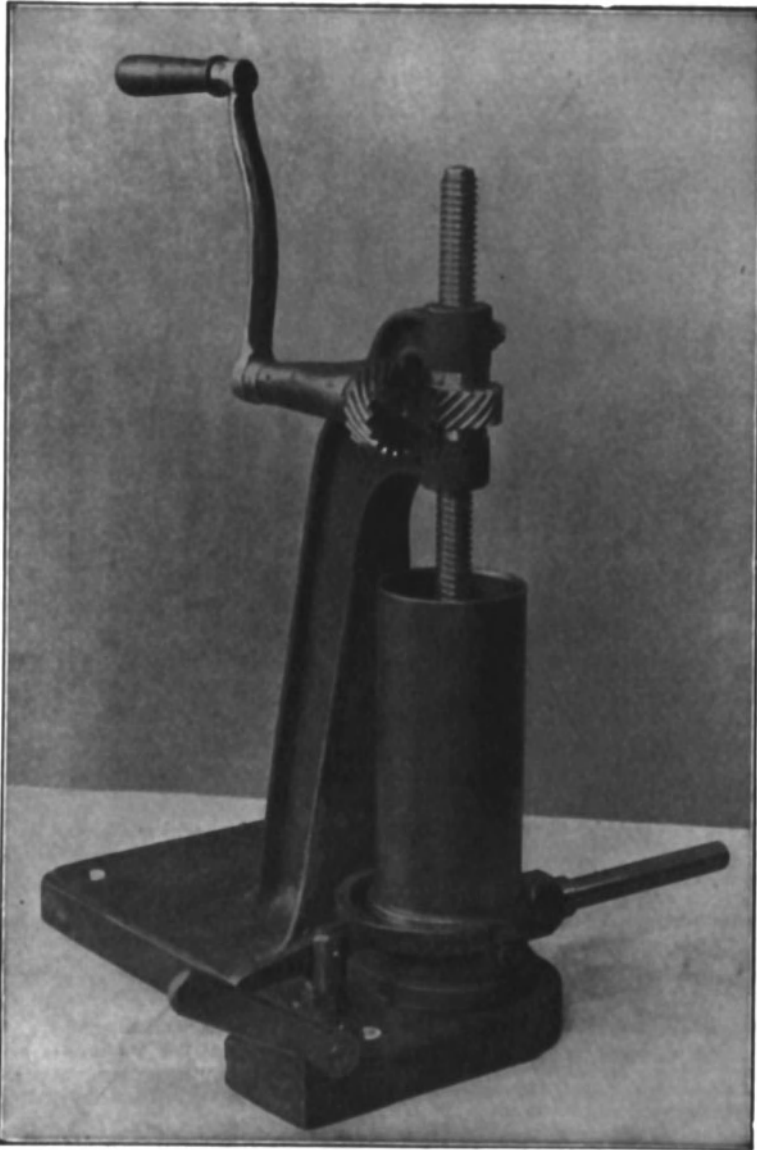
Abb. 144. Tubenfüllmaschine für Handbetrieb.
