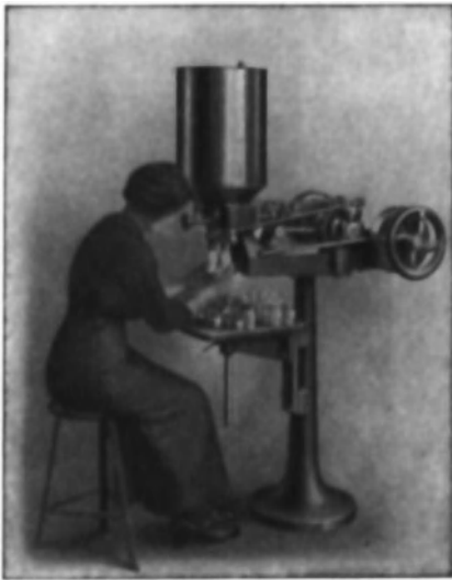
Abb. 11. Abfüllmaschine für zähflüssige Stoffe.
