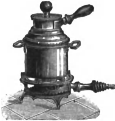
Abb. 54. Aufguß-(Infundier-)Apparat aus Kupfer ohne Lötung.
