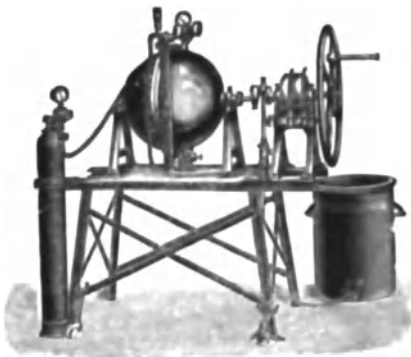
Abb. 62. Kesselapparat mit Schwunradpumpe und Wasserstand.
