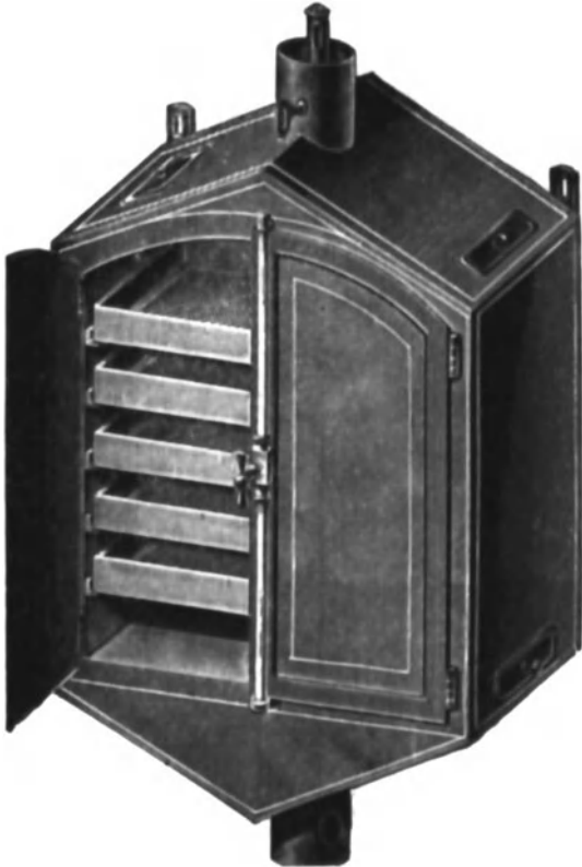
Abb. 138. Hordentrockenschrank aus Eisen.
