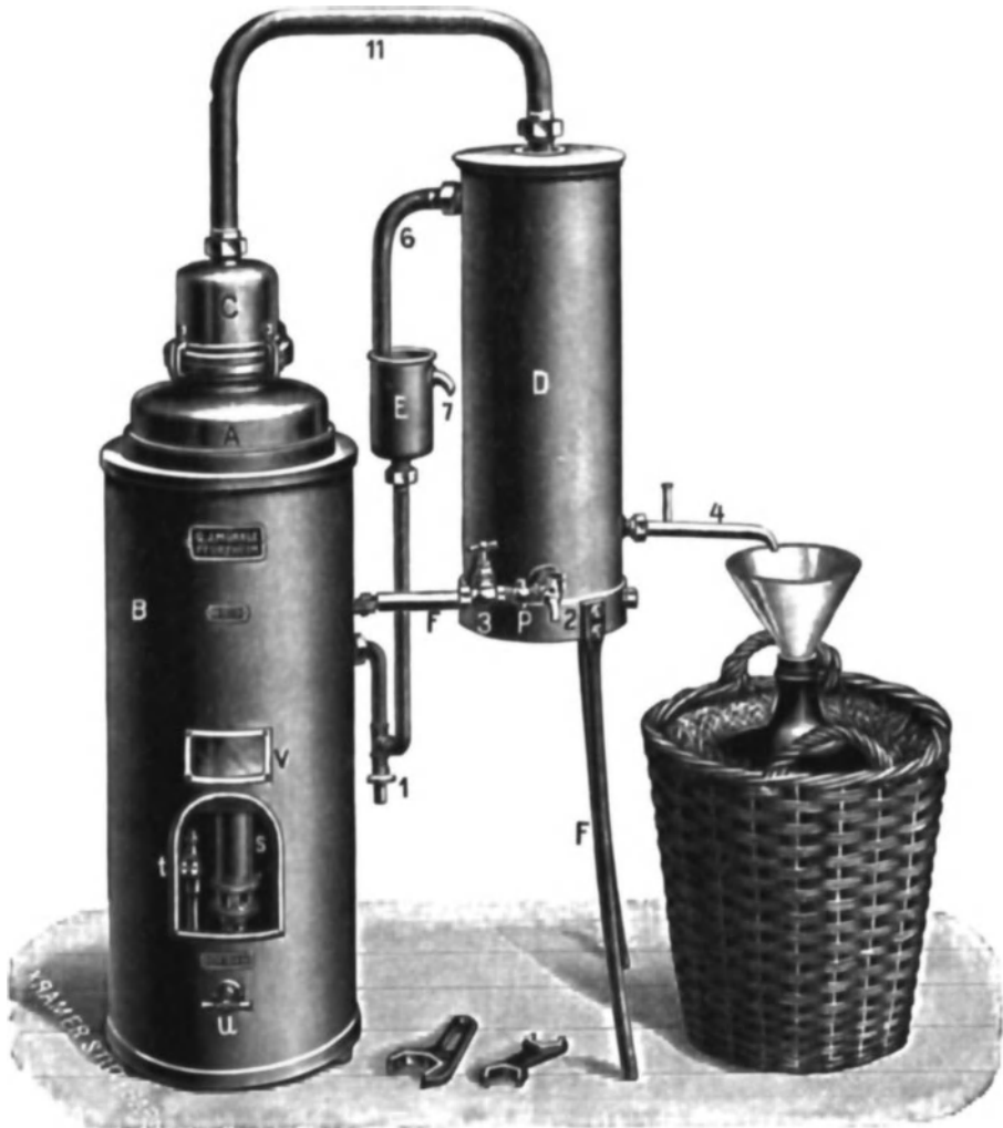
Abb. 31. Wasserdestillierapparat für Gasheizung.
