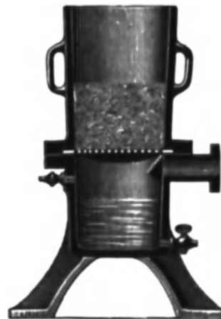
Abb. 17. Heizbares Vakuumfilter (Nutschapparat) für Laboratorien.
