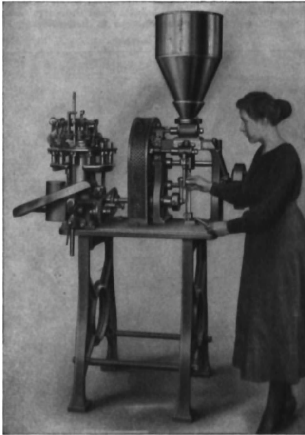
Abb. 145. Tuben-Füll- und Schließmaschine.
