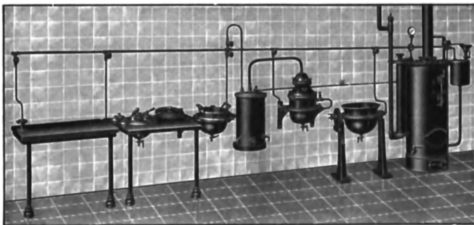
Abb. 32. Moderne Anlage mit gespanntem Dampf, Destillierapparat, Dekoktorium, Abdampftisch, Vakuum usw.
