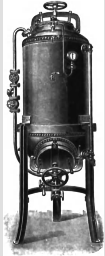
Abb. 21. Einzelner Extrakteur zur Extraktion von Kräutern, Rinden, Wurzeln usw.
