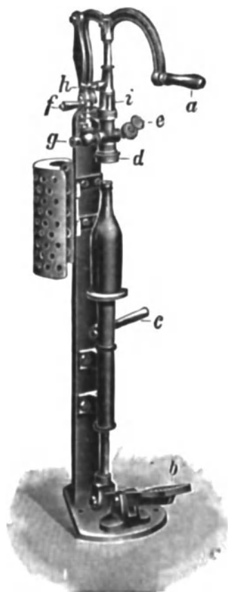
Abb. 64. Kombinierte Abfüllmaschine für Kork-, Patent- u. Kugelflaschen.
