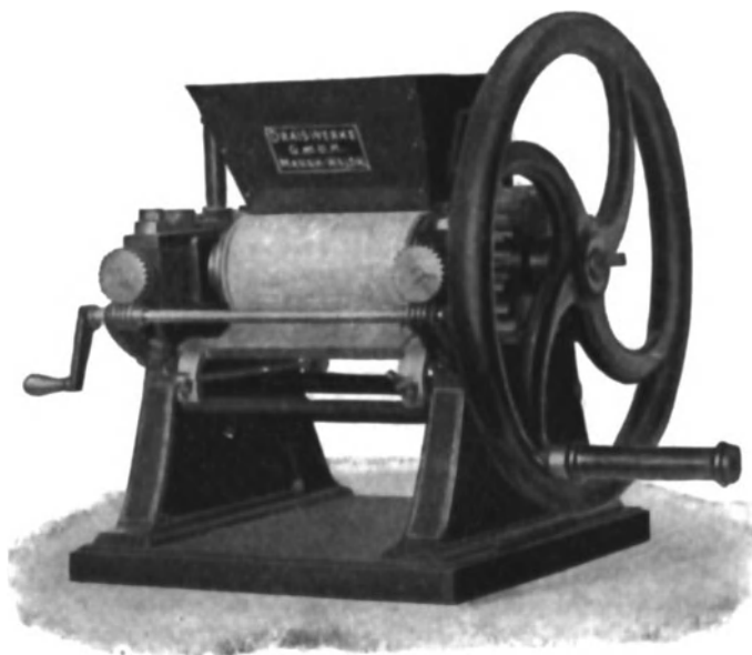
Abb. 143. Zweiwalzenmaschine für Handbetrieb mit Porphyrwalzen.
