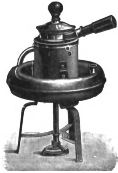
Abb. 55. Schnell-Aufguß-(Infundier-)Apparat mit beständigem Wasserstand.
