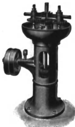
Abb. 141. Salbenreibmaschine mit zwei Pistillen.
