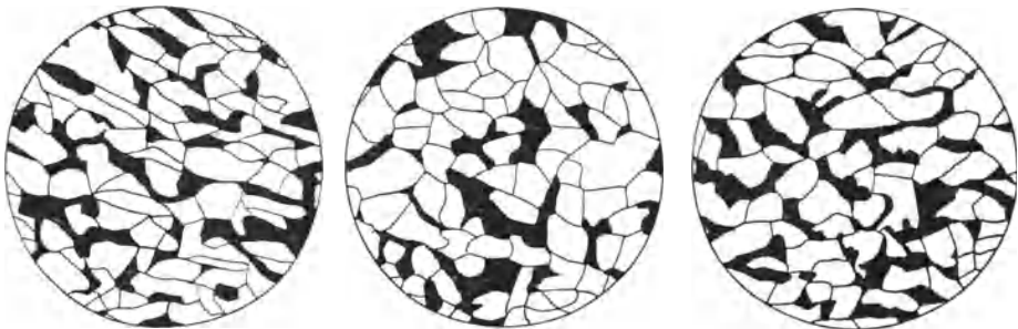
Fig. 205. Kleingefüge des kalt in einem Vierkant ausgeschmiedeten Rundstab, Fig. 204.
