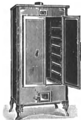
Trockenofen für Gasheizung.
