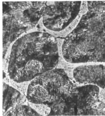
Abb. 43. Gefüge eines emailierfähigen Gußeisens mit perlitischer Grundmasse und Phosphideutektikum (nach OBERHOFER).
