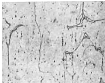
Abb. 32. Rekristallisiertes, sehr grobkörniges Stahlblech mit Korngrenzenzementit (nach v. SCHWARZ).
