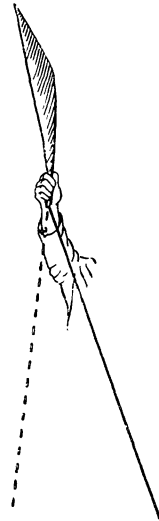
Abb. 37. Modell eines Flügels, hergestellt mit METZELER-Fliegerstoff. Die punktierte senkrechte Linie zeigt die Richtung des gewollten Schlages an. Die ausgezogene Linie die des tatsächlich ausgeführten. (Schema. In Wirklichkeit ist die letztere Linie eine Parabel infolge der sich immer stärker komprimierenden Luft.) (Nach ERHARD.)
