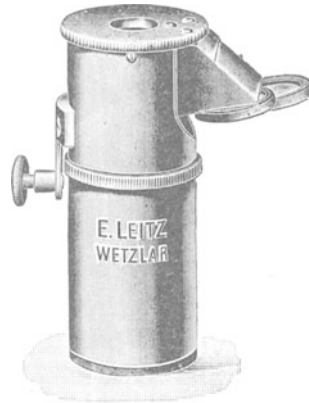
Fig. 50. Zeichenokular von LEITZ.
