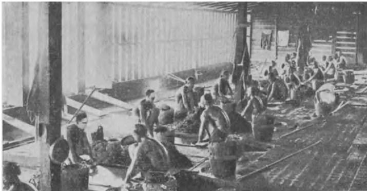
Abb. 4. Reinwaschen des Zinnerzes in Schalen.
