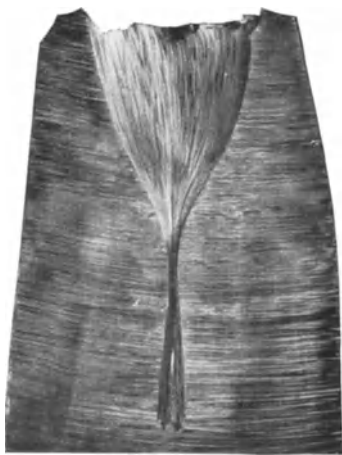
Abb. 52. Trichterbildung bei einem restlos verpreßten Messingblock. ( \frac{9}{10} nat. Größe.)
