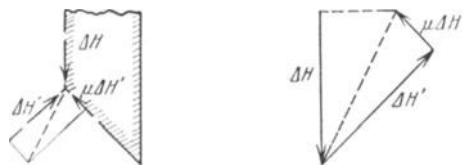
Abb. 26. Halterkraft bei schrägem Faltenhalter.
