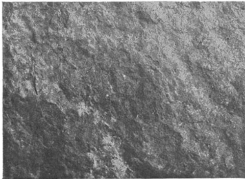
Abb. 177. Anfangsstadium. Erste Andeutung der hellen Flecken bei dem durch unebene Oberfläche verdächtigen Gestein. (Natürliche Größe.)
