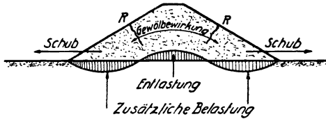
Abb. 457. Gewölbewirkung bei einem Damm infolge ungleichmäßiger Zusammendrückung des Bodens an der Dammsohle. R Risse im Damm.
