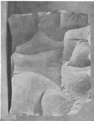
Abb. 188. Kryptokristalliner, leicht mergeliger Kalkstein. Muscheliger Bruch. Glatte, matte Bruchflächen.
