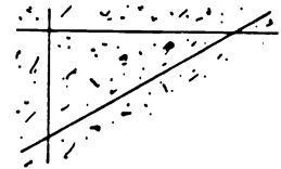
Abb. 371. Flächenelement besteht aus einer großen Zahl von Körnern, als Grundlage für die Rankinesche Erddrucktheorie.
