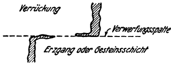
Abb. 20. Auslenkung einer Gesteinsschicht.
