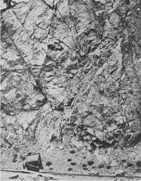
Abb. 173. Stark klüftiger Granit. Ist trotz der im Handstück festen und massigen Beschaffenheit nur als Schotter verwertbar.
