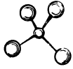
Abb. 321. Selbstständige \text{SiO}_4 -Gruppe. Keine gemeinsame Ecken mit anderen \text{SiO}_4 -Tetraedern. Große Kugeln = O; kleine Kugeln = Si.
