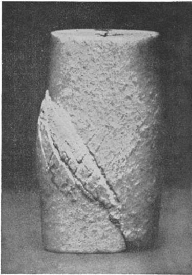
Abb. 364. Bruchflächen in einem Marmor. Druckversuch unter allseitigem Druck. \sigma = 380 \text{ kg/cm}^2 , \varnothing = 20 \text{ mm} , Höhe = 45 mm.
