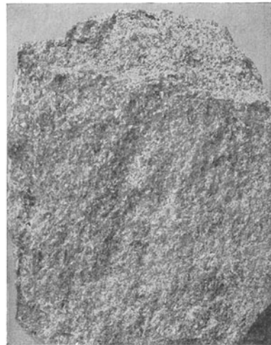
Abb. 189. Kalkstein, reich an Fossiltrümmern (spätige Struktur mit sehr ungleichem Korn). Oberfläche rauh. Sprödigkeit geringer als bei feinkristalliner Struktur.
