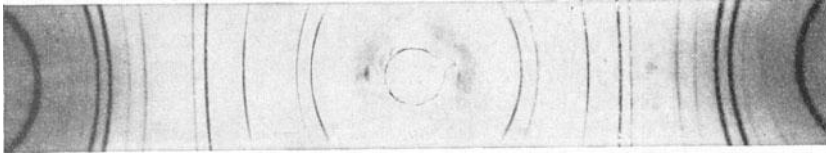
Abb. 10. Debye-Scherrer . Aufnahme von Platin.
