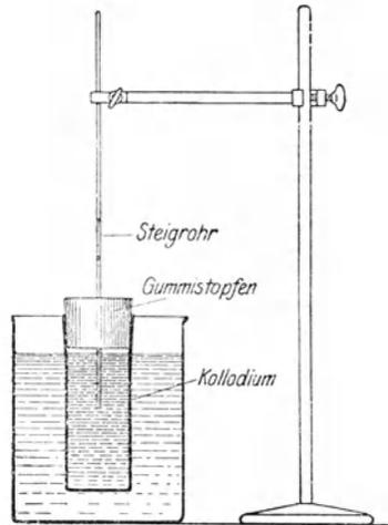
Abb. 8. Einfaches Osmometer.
