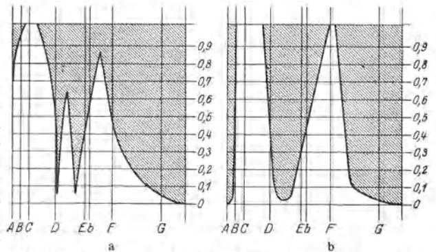
Abb. 88. Absorption von Oxy-Hämoglobin- (a) und von Hämoglobinlösungen (b) in Abhängigkeit von der Konzentration. Ordinate: Farbstoffkonzentration. Abszisse: Wellenlänge des Lichtes. (Nach ROLLER.) Die schraffierten Flächen bedeuten Lichtabsorption. Die beiden Absorptionsstreifen des Hb—O<sub>2</sub> sind also nur in einem bestimmten Konzentrationsbereich (etwa von 0,1—0,6) sichtbar.
