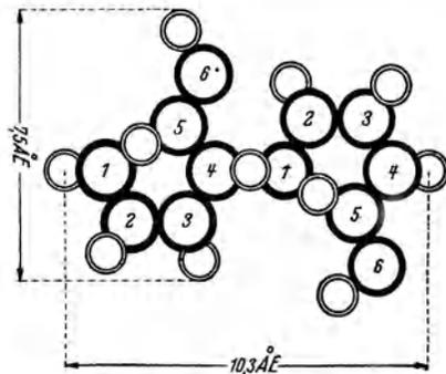
Abb. 2. Modell des Cellobioserestes. Die Nummern bezeichnen die C-Atome der beiden Glucoseringe. Die doppelt umrandeten Ringe sind die Sauerstoffatome. (Nach MEYER und MARK.)
