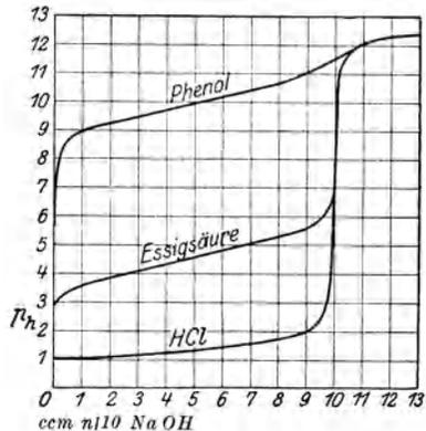
Abb. 10. Elektrotitrationskurven von Salzsäure, Essigsäure und Phenol. Je 10 cm der betr. Säuren in  $n/1$ -Lösung werden mit steigenden Mengen von  $n$  NaOH versetzt. Die Kurven ergeben sich aus den einzelnen Laugezusätzen entsprechenden  $\text{pH}$ -Werten.
