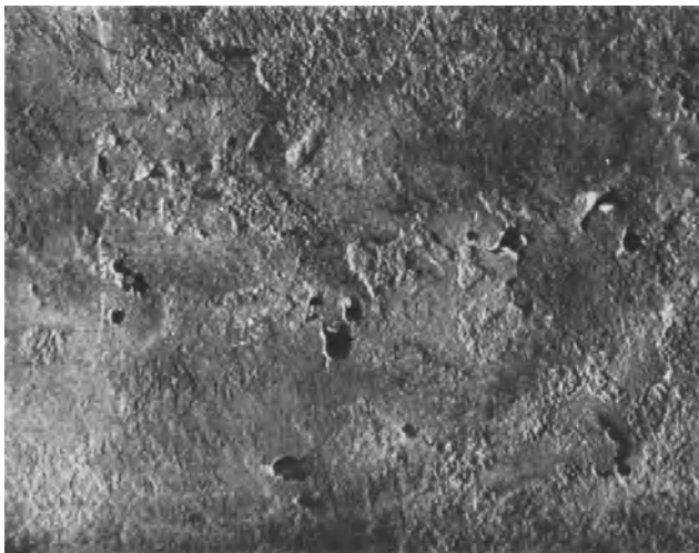
Abb. 96 ( V = 3 ). Siebartige Durchlöcherungen eines aufgebogenen Messingrohrs der Legierung 70/29/1; aus den Schlagschatten in den Löchern sind die verschiedenen Richtungen der Durchfressungen erkenntlich (s. S. 64).
