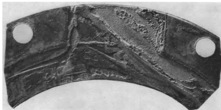
Abb. 92 ( V = 4,5 ). Elektrolytische Korrosion mit jahresringartig verlaufender Korrosionslinie an einer Getrieblanke. Der zum Teil nur 0,2 mm breite Rand zwischen Zahnkopf und flächenartiger Anfrassung (im Bild links) zeigt kleine muldenförmige Korrosionen genau wie Abb. 93 und 104 (s. S. 58).
