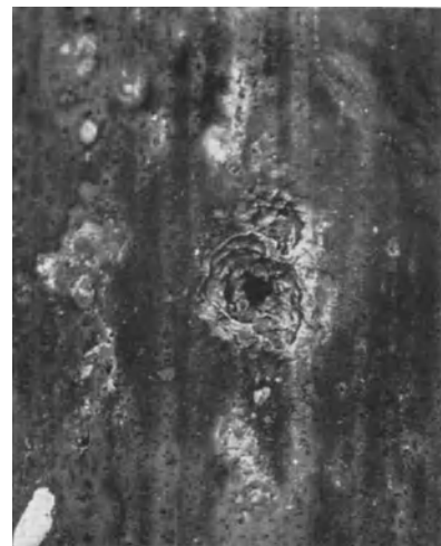
Abb. 26 ( V = 2 ). Anfrassung an einem kupfernen Kondensatorrohr, Brinellhärte 111 \text{ kg/mm}^2 mit besonders deutlichen nebeneinanderliegenden muldenartigen Korrosionen nebst den jahresringartig verlaufenden Korrosionslinien (s. S. 13).
