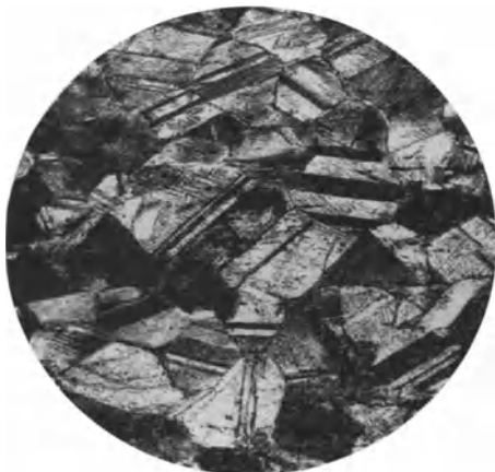
Abb. 45 ( V = 100 ). Längsschliff eines Kondensatorrohres der Legierung 70/29/1, Brinellhärte 115, ziemlich grobes Gefüge (s. S. 21).
