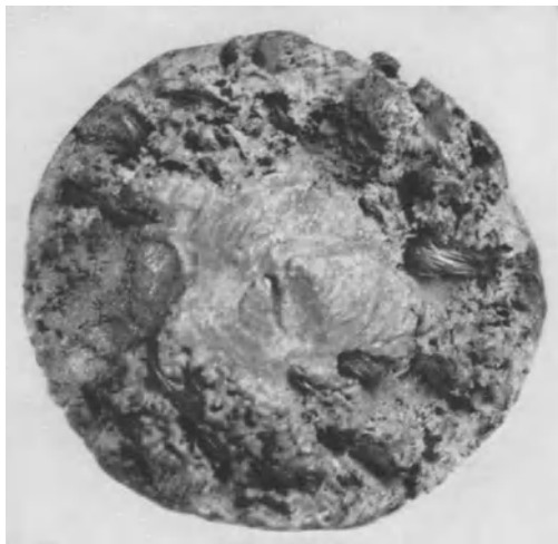
Abb. 76 (natürliche Größe). Kraterartige Anfröschung an der Stirnfläche des turbinenseitigen Wellenendes (s. S. 51).
