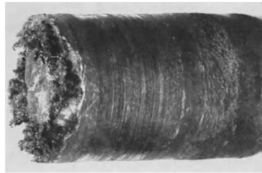
Abb. 75 (natürliche Größe). Turbinenseitiges Wellenende im Druckausgleichsraum A , direkt neben der Stopfbuchse abgebrochen (s. S. 50).
