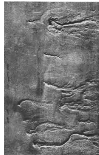
Abb. 98 ( V = 1,2 ). Anfressungen durch Säure an der Außenwand eines bei der chemischen Kondensatorreinigung stark korrodierten Messingrohrs (s. S. 64).
