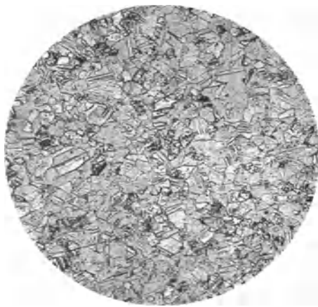
Abb. 51 ( V = 100 ). Querschliff eines Kondensatorrohres der Legierung 70/29/1, Brinellhärte 133 kg/mm 2 ; feine, ziemlich gleichmäßige \alpha -Kristalle (s. S. 24).
