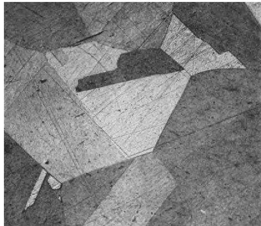
Abb. 42 ( V = 100 ). Sehr grobes Gefüge aus dem in Abb. 22 gezeigten korrodierten Rohr der Legierung 70/29/1, Brinellhärte 72 kg/mm 2 (s. S. 21).
