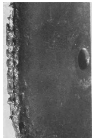
Abb. 34 (natürliche Größe). Künstliche Korrosion an einer Kupferanode; der Stromaustritt erfolgte nur an dem blanken äußeren Umfang (s. S. 18).
