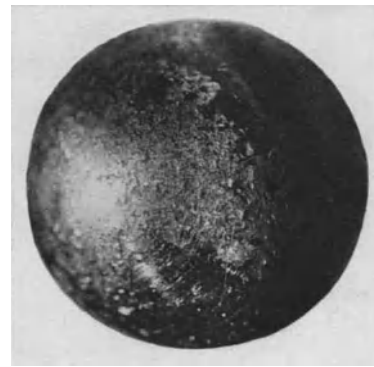
Abb. 86 ( V = 3 ). Elektrolytische Korrosion an einer Stahlkugel aus einem Kugellager (s. S. 57).
