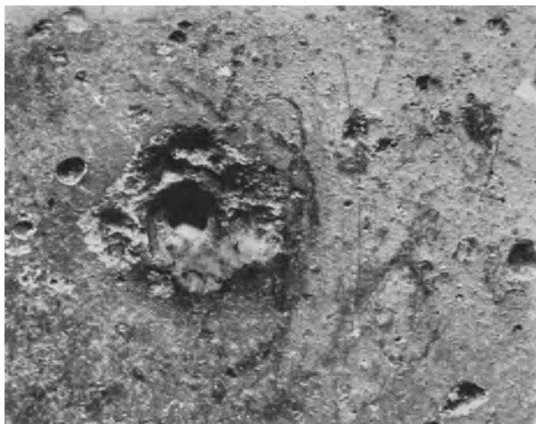
Abb. 27 ( V = 1,7 ). Anfrassungen an einem 5 mm starken gewalzten Flußeisenblech, Brinellhärte 121 \text{ kg/mm}^2 (s. S. 13).
