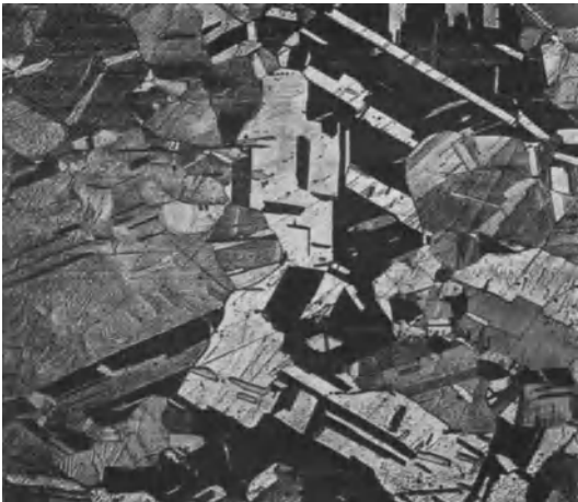
Abb. 43 ( V = 100 ). Grobes, sehr unregelmäßiges Gefüge aus dem in Abb. 23 gezeigten korrodierten Messingrohr der Legierung 70/29/1, Brinellhärte 110 (s. S. 21).
