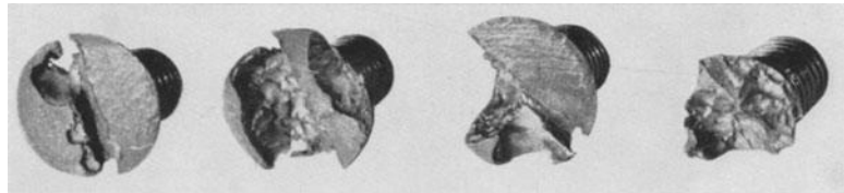
Abb. 68 ( 1/2 natürliche Größe). Korrodiertes Bronzedichtungring einer Kreiselpumpe, Brinellhärte 74 kg/mm 2 (s. S. 46).
