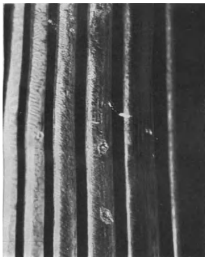
Abb. 91 (natürliche Größe). Elektrolytische Korrosion an einem Zahnkranz mit Schrägverzahnung. Grübchen in der Nähe des Teilkreises (s. S. 58).
