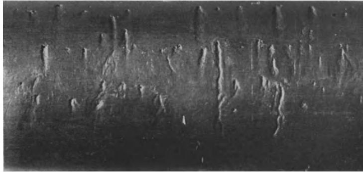
Abb. 99 ( V = 2,5 ). Durch chemische Entzinkung nach dreimaliger Säurereinigung und insgesamt 9780 Betriebsstunden entstandene poröse Stellen an einem Kondensatorrohr der Legierung 62/38 (s. S. 67).
