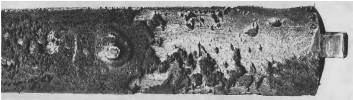
Abb. 107 (natürliche Größe). Silberglänzende, leicht aufgeraute 2 bis 3 mm tiefe Anfrassungen mit inselartig stehengebliebenen Erhöhungen und besonders dicker Oxydschicht auf der Hohlseite der Niederdruckschaufel einer 50000 kW-Turbodynamo; der Schaufelrücken ist nur mit einer hauchdünnen leicht aufgerauten Oxydschicht bedeckt mit geringen Spuren von leichten Korrosionen (s. S. 75).
