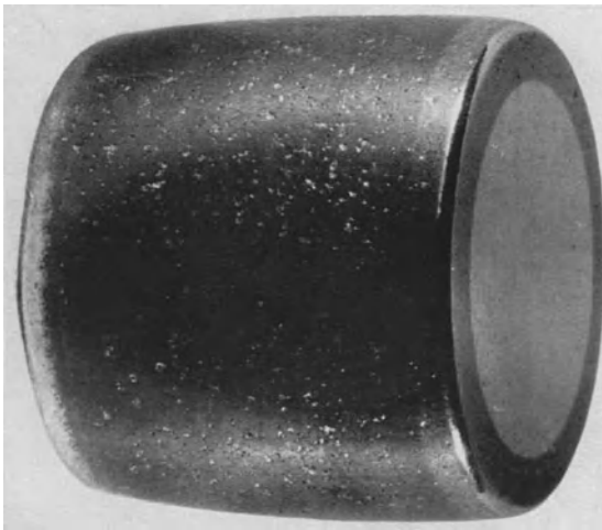
Abb. 85 ( V = 2,3 ). Elektrolytische Korrosionen an einer Stahlrolle aus einem als Tatzlager für einen Straßenbahnmotor benutzten Rollenlager (s. S. 56).
