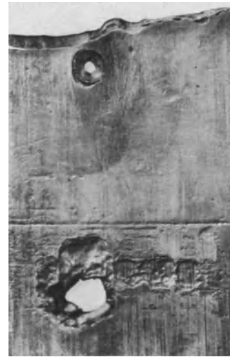
Abb. 2 ( V = 1,7 ). Oben runde kraterförmige Korrosion an einem Kondensatorrohr aus 98% Cu, 1½% Zinn, Brinellhärte 113 kg/mm 2 ; unten unregelmäßige Korrosion quer zur Ziehrichtung, ferner ist die Rohrstrirnfläche (im Bild oben) ringsherum durch muldenförmige Korrosionen scharfkantig weggefressen (s. S. 10 u. 35).
