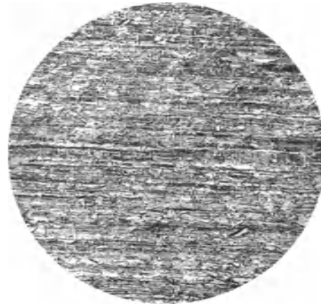
Abb. 48 ( V = 100 ). Längsschliff aus demselben Kondensatorrohr wie Abb. 47; stark gerecktes Gefüge (s. S. 24).
