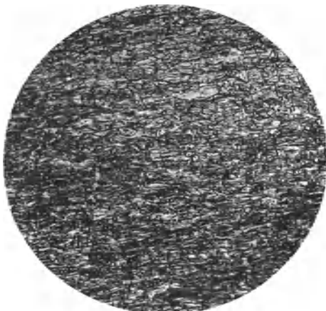
Abb. 49 ( V = 100 ). Querschliff eines Kondensatorrohres 85% Cu, 15% Ni; Brinellhärte 116 kg/mm 2 ; einheitliche Kristalle (s. S. 24).
