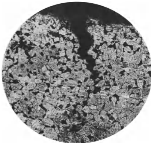
Abb. 101 ( V = 100 ). Querschliff durch eine besonders stark entzinkte Stelle des Rohrs der Abb. 99. Nach 9780 Betriebsstunden und dreimaliger Säurereinigung ist die Rohrwand zum größten Teil durchgefressen. Die dunklen Stellen des Schliffbildes sind herausgefressene \beta -Kristalle, die zum Teil durch niedergeschlagenes Kupfer ersetzt sind (s. S. 67).
