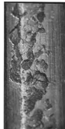
Abb. 92 ( V = 4,5 ). Elektrolytische Korrosion mit jahresringartig verlaufender Korrosionslinie an einer Getrieblanke. Der zum Teil nur 0,2 mm breite Rand zwischen Zahnkopf und flächenartiger Anfrassung (im Bild links) zeigt kleine muldenförmige Korrosionen genau wie Abb. 93 und 104 (s. S. 58).
