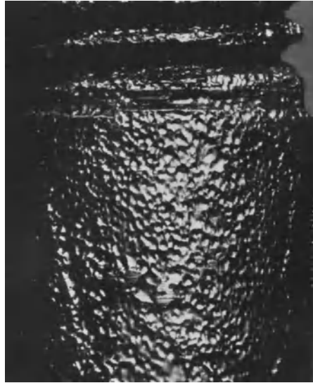
Abb. 65 ( V = 4 ). Korrosion am oberen Teil der in Abb. 64 gezeigten Stiftschraube (s. S. 44).
