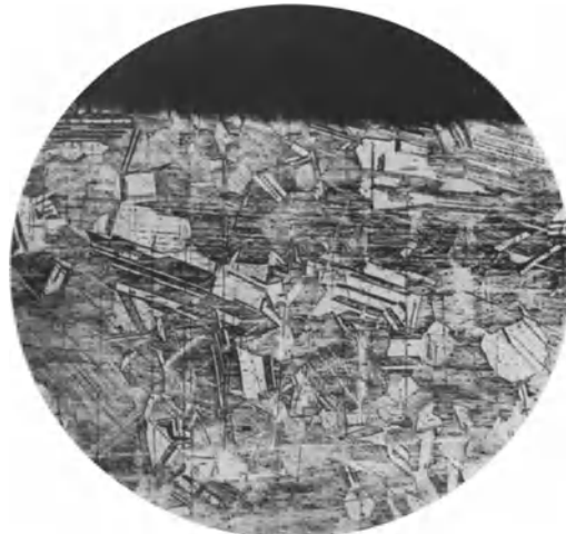
Abb. 102 ( V = 100 ). Querschliff eines Kondensatorrohrs der Legierung 70/29/1. Brinellhärte 121 kg/mm 2 . Nach 42000 Betriebsstunden und achtmaliger Säurereinigung ist das Gefüge im Gegensatz zu Abb. 101 vollständig unversehrt, trotzdem die Rohre der Abb. 101 und 102 in demselben Kraftwerk unter genau gleichen Kühlwasserverhältnissen in Betrieb waren (s. S. 67).
