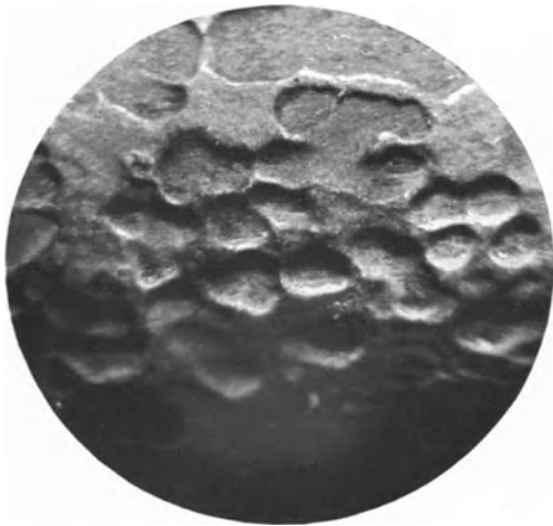
Abb. 6 ( V = 15 ). Korrosionen an einem Kondensatorrohr der Legierung 70/29/1 (s. S. 10).
