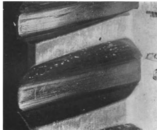
Abb. 90. Elektrolytische Korrosionen an den Zahnflanken eines Bronzeschneckenrades für den Antrieb einer Zahnradölpumpe und des Fliehkraftreglers einer Turbodynamo (s. S. 58).
