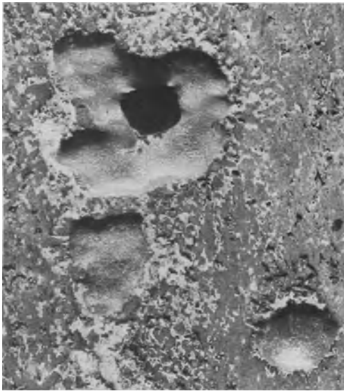
Abb. 3 ( V = 5 ). Unregelmäßige Korrosion an einem Kondensatorrohr der Legierung 70/29/1, Brinellhärte 106 kg/mm 2 (s. S. 10).
