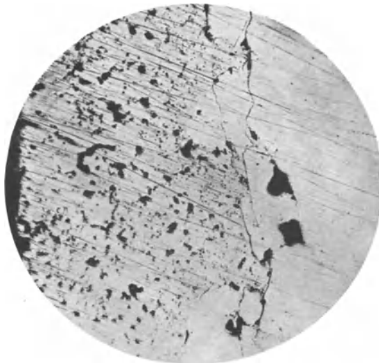
Abb. 57 ( V = 100 ). Ungeätzter Querschliff des in Abb. 55 gezeigten korrodierten Rohres. Rechts gesundes Messinggefüge, links Gefüge der entzinkten Kupferablagerungen, durchsetzt mit kleinen Hohlräumen (s. S. 33).
