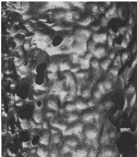
Abb. 19 ( V = 5 ). Kraterartige Korrosion eines Teils der Abb. 18, entsprechend vergrößert (s. S. 12).
