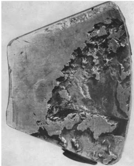
Abb. 89 ( V = 1,6 ). Elektrolytische Korrosionen an der Weißmetall-Laufläche eines Druckklotzes aus dem Klotzlager einer 8000 kW-Turbodynamo (s. S. 57).
