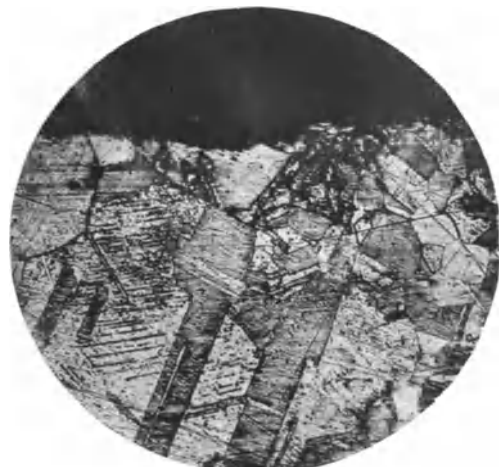
Abb. 40 ( V = 100 ). Ziemlich grobes Gefüge aus dem in Abb. 8 gezeigten korrodierten Messingrohr der Legierung 70/29/1 (s. S. 21).
