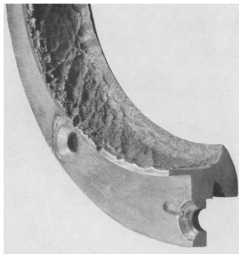
Abb. 67. Korrodiertes Dichtungsring (Nickelmessing) aus einer Kreiselpumpe, Brinellhärte 95 kg/mm 2 (s. S. 46).
