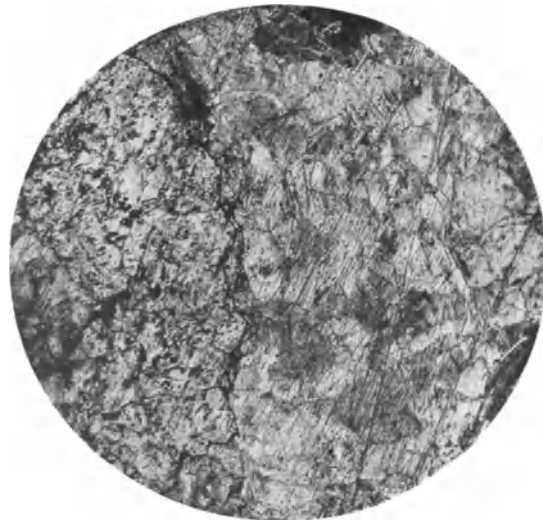
Abb. 58 ( V = 100 ). Geätzter Schliff des in Abb. 55 gezeigten korrodierten Rohres. Rechts gesundes Messinggefüge, links Gefüge der entzinkten Kupferablagerungen, durchsetzt mit kleinen Hohlräumen (s. S. 33).
