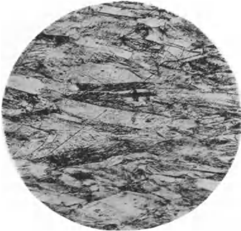
Abb. 35 ( V = 100 ). Längsschliff eines hartgezogenen Kondensatorrohres der Legierung 70/29/1, grobes Gefüge, Brinellhärte 148 kg/mm 2 (s. S. 20).
