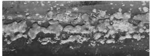
Abb. 24 ( V = 1,3 ). Korrodiertes Messingrohr der Legierung 70/29/1 eines Berieselungskühlers. Elektrolyt: salzhaltiges Kühlwasser aus dem Atlantischen Ozean (s. S. 13).
