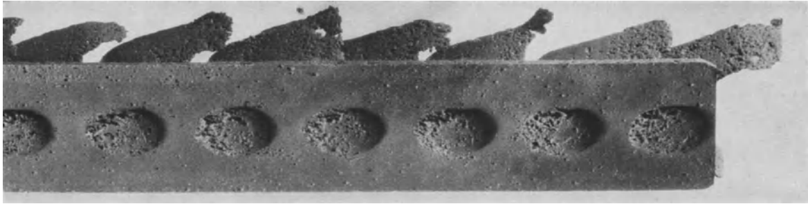
Abb. 106 ( V = 1,75 ). Wurmstichartige Anfrassungen an Schaufeln, Nietköpfen und Bandage aus V5M-Stahl vom ersten Kranz des Hochdruckrads einer elfstufigen 2000 kW-Anzapf-Kondensationsturbine (Dampfdruck vor der Turbine 20 atü 360°) (s. S. 75).
