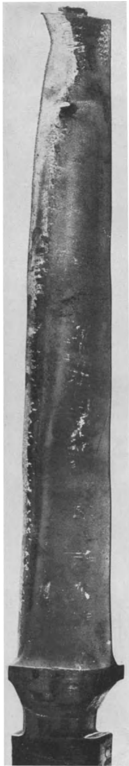
Abb. 103. Starke Abnutzung der Dampfeintrittskante einer Turbinenschaufel am äußeren Ende, nach unten schmal verlaufend und anschließend auf der dunklen Oxydschicht des Schaufelrückens scharf umgrenzte, silbergraue Anfrassungen von unregelmäßiger Form (s. S. 74).
