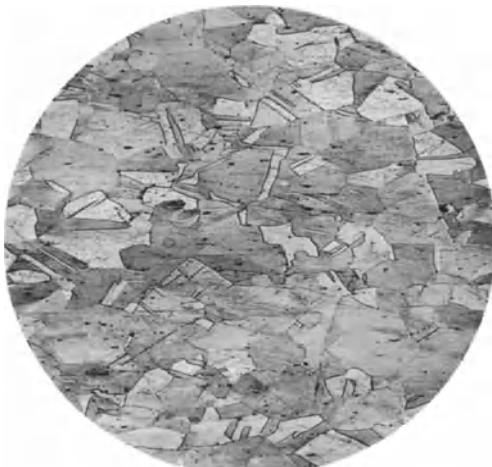
Abb. 39 ( V = 100 ). Gefüge des in Abb. 2 gezeigten korrodierten Kupferrohres, Brinellhärte 113 kg/mm 2 (s. S. 21). Siegel, Korrosionen.
