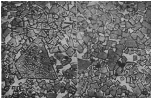
Abb. 36. Gefüge eines gesinterten Karbidschneidmetalles.
