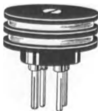
Abb. 724. Leicht auswechselbarer eisenloser Kopplungs- transformator.
