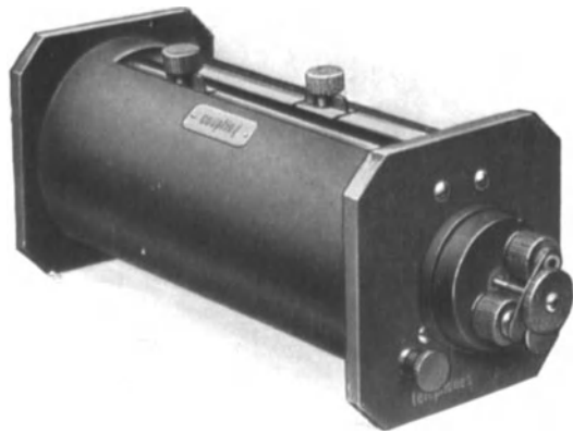
Abb. 142. Einfacher Schiebespulenempfänger mit aufgestöpseltem Kristalldetektor von G. Seibt.
