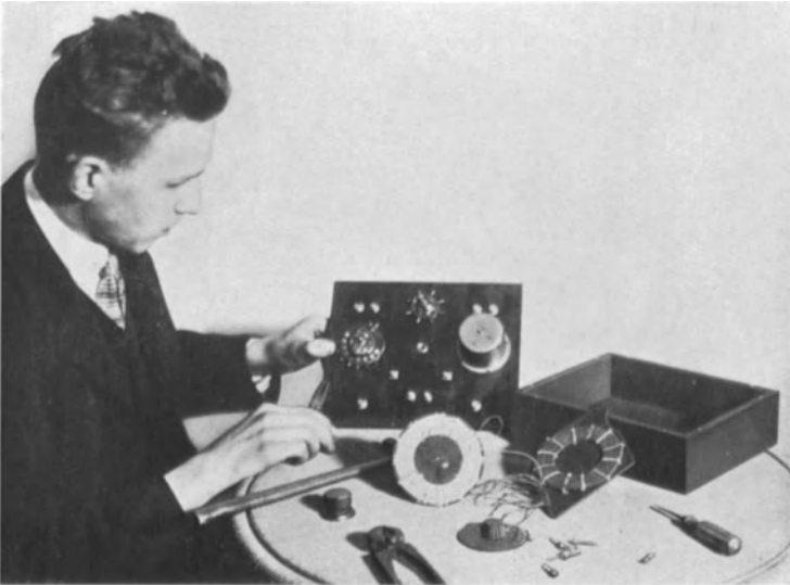
Abb. 919. 3. Stadium: An der Schaltplatte sind von der Rückseite aus die Kontaktbahnen und der Drehkondensator sowie die schon im Stadium 2 erwähnten Kontakt- und Schaltelemente angebracht.
