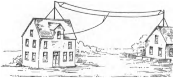
Abb. 556. Richtige Anordnung und Ableitung einer T-Antenne.
