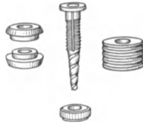
Abb. 791. Einzelteile der Verbindungsklemme „Clox“. Links ein Paar Durchführungsbuchsen. In der Mitte oben der Klemmenstecker, darunter die Gegenmutter. Rechts der Isolator.
