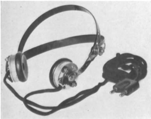
Abb. 492. Telephon mit ausgesprochener Resonanzlage für Radiotelegraphie von H. W. Sullivan.
