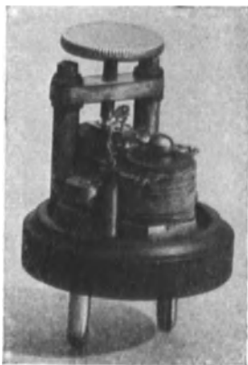
Abb. 772. Summer mit nahezu geschlossenem Eisenweg von G. Seibt.
