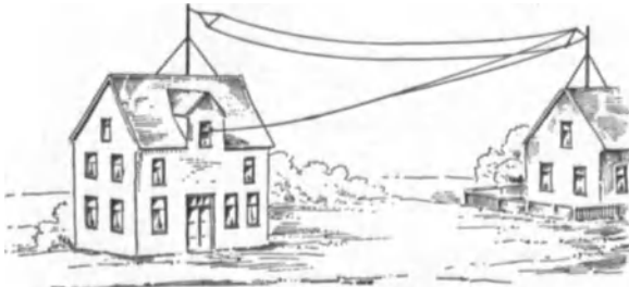
Abb. 557. Unzweckmäßige Anordnung einer L-Antenne.
