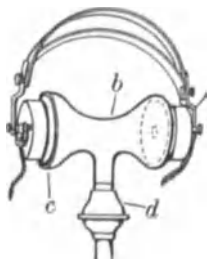
Abb. 507. T-Rohrstück mit einem Doppelkopfhörer behelfsmäßig verbunden.
