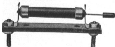
Abb. 768. Einstellbarer Gitterableitungswiderstand sehr geringer Kapazität von Durham & Co., Philadelphia.
