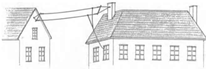
Abb. 559. Elektrisch günstigere Antennenanordnung.
