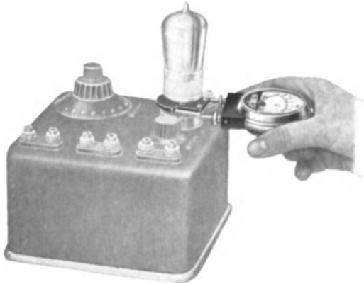
Abb. 943. Anhalten des Voltmeters an den Röhrenzwischenstecker (Aron E.-G.-Dr. S. Guggenheimer).
