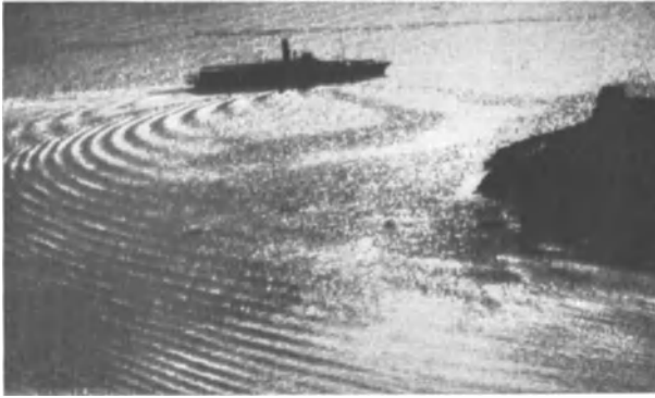
Abb. 29. Analogon der „Wellenkräuselung“ bei den Wasserwellen. Durch die Fahrt des Dampfers werden die den Trägerwellen analogen Wasserwellen erzeugt. Diese werden durch den leicht über das Wasser hinstreichenden Wind „gekräuselt“. Dieses entspricht der Modulation durch das Mikrophon des Radiotelephoniesenders.
