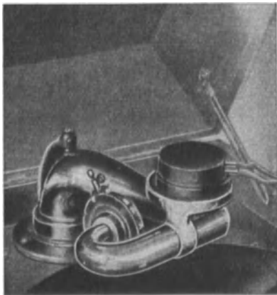
Ab. 511. Benutzung des Grammophonschalltrichters zu Lautsprecherzwecken.
