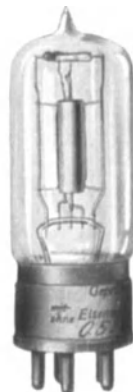
Abb. 433. Gasenthaltende Detektorröhre Type C 300 von Cunningham.
