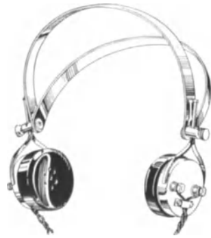
Abb. 487. Bügelanordnung mit Einsteckvorrichtung beim Doppelkopftelephon von J. G. Brown Ltd., London.
