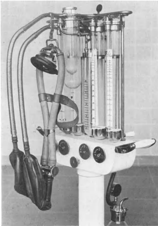
Abb. 163. Dosiergerät nach KILLIAN für alle Gas- und Inhalationsnarkosen, mit Überdruckeinrichtung, Ventilations- und Saugereinrichtung.
