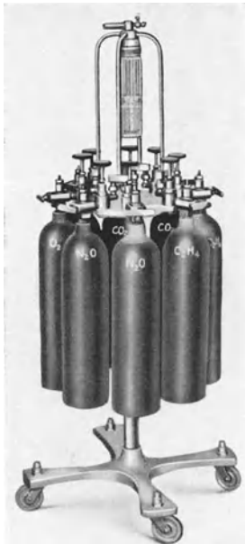
Abb. 144. Klinik-Narkoseapparat mittlerer Größe von FOREGGER mit GWATHMEY-Dosierung.
