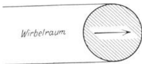
Abb. 14. Strömung um einen Zylinder bei \mu \rightarrow 0 nach OSEEN.
