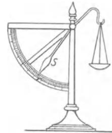
Abb. 87. Zeigerwaage (automatische W.).
