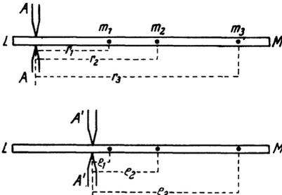
Abb. 112. Dieselben Massenpunkte  $m$  stehen von der *einen* Achse um  $r$ , von der *anderen* um  $e$  ab.
