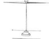
Abb. 528. Magnetnadel (um vertikale Achse drehbar).
