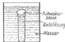
Abb. 262. Wirkung des osmotischen Druckes.
