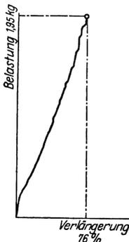
Abb. 167. Dehnungs-elastizität eines Einkristalldrahtes.
