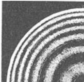
Abb. 732. NEWTONSche Ringe im homogenen reflektierten Licht.
