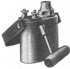
Abb. 74. Ansicht einer magnet- elektrischen Zündmaschine mit Drehschlüsselantrieb.
