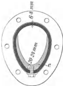
Abb. 121. Spülrohr mit eiförmigem Querschnitt und Walzeisenanlage.
