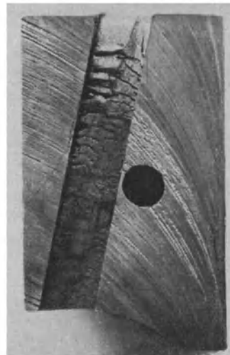
Fig. 113. Sägenschnitt durch die Bohrung.
