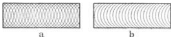
Abb. S 8 a und b. Schleifbild bei genau senkrecht stehender und bei etwas geneigter Schleifspindel.
