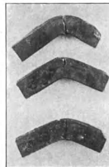
Biegeproben, am Rand von Nietlöchern mit Riefen entnommen und geprüft im Einlieferungs-Zustand im ausgeglühten Zustand.
