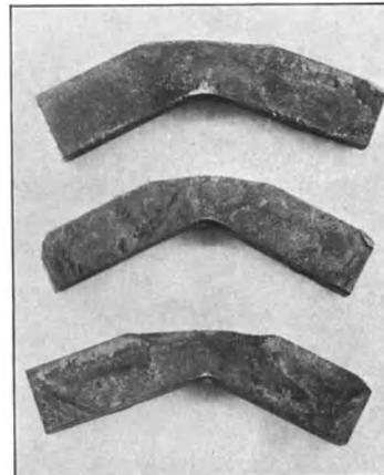
Stabachse parallel der Lochachse. Zugbeanspruchung bei der Biegung am Lochrand (oben).
