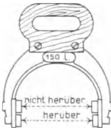
Fig. 111. Grenzrachenlehre mit auswechselbaren Backen.
