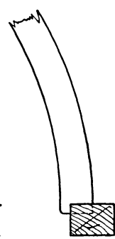
Abb. 202. Auflager auf einer Schwelle.
