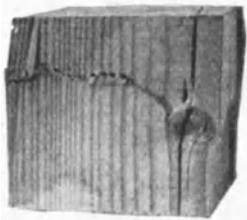
Abb. 22. Zerstörung eines Tannenwürfels bei Druck längs zur Faser.
