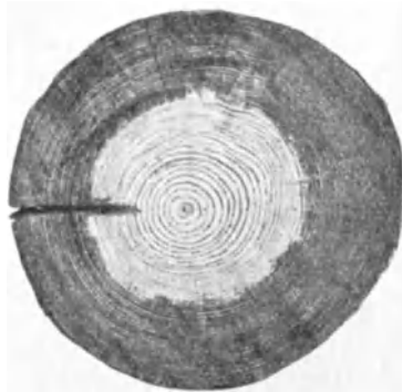
Abb. 18. Querschnitt einer nach dem Rüping-Verfahren imprägnierten Telegraphenstange.
