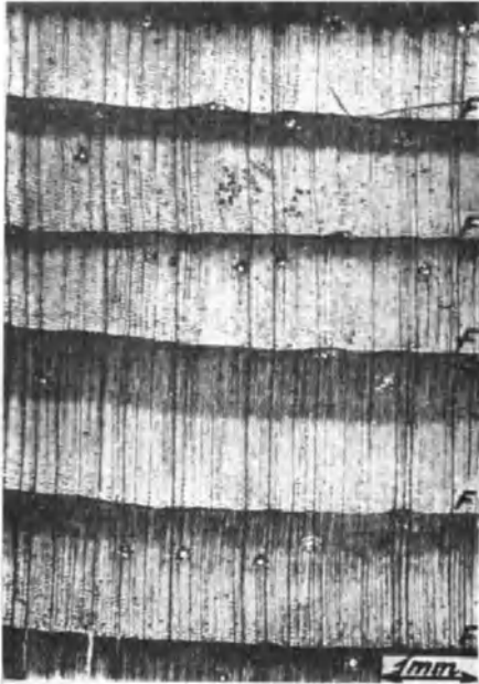
Abb. 10. Querschnitt durch Kiefernholz. V.: 11.
