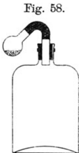
Fig. 58. Verbrennen von Arsen-, Antimon-, Wismutpulver in Chlorgas.
