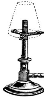
Bunsenbrenner mit Aufsatz aus Eisenblech zum Ruhighalten der Flamme.
