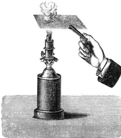
Eine Flamme wird durch ein Drahtgewebe aufgehalten.
