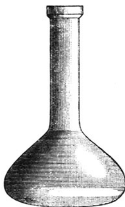
Tonfilter nach Haldenwanger oder Pukall zum Filtrieren von außen und innen.
