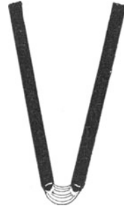
Fig. 242. Lichtbogen bei schräg nebeneinander angeordneten Kohlen.
