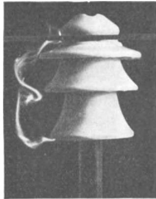
Fig. 187. Spannungsüberschlag bei einem Isolator in trockener Luft.
