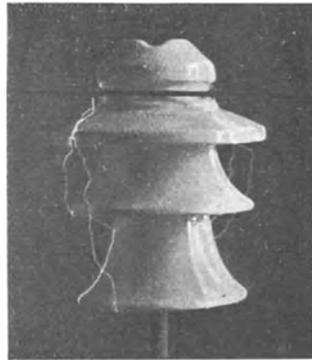
Fig. 195. Spannungsüberschlag bei einem Deltaisolator.
