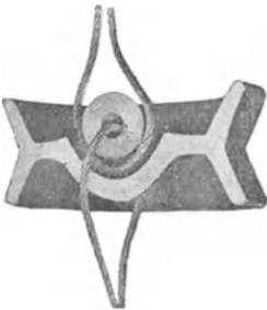
Fig. 212. Durchschnitt durch einen Hewlett-Isolator.
