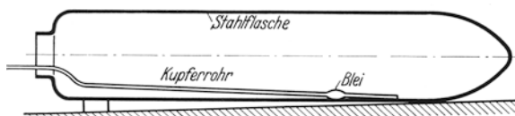
Abb. 2. Berührungskorrosion in einer Stahlflasche: Schematische Skizze.
