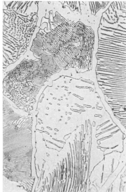
Abb. 100. Sekundärer Zementit (Korngrenzenzementit) in Perlit. V 1200×.
