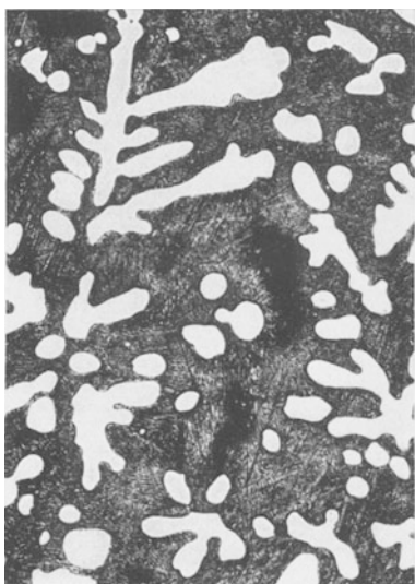
Abb. 102. Kupferzinklegierung mit 5% Cu. Langsam erstarrt.
