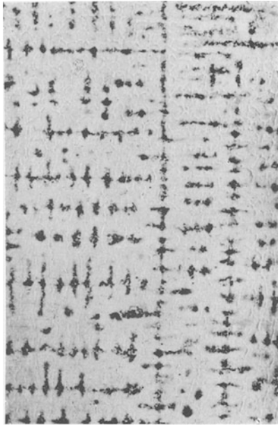
Abb. 14. Ätzung auf Phosphor (Kristallsaigerung) mit dem OBERHOFFERSCHEN Ätzmittel.
