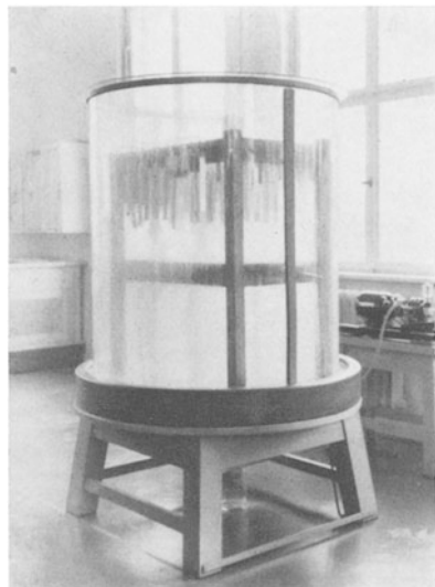
Abb. 31. Sprühgerät, Bauart Chem.-Techn. Reichsanstalt.
