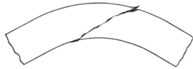
Abb. 30. Zubruchgehen einer Feuerschweißung infolge schlechter Bildung an der Schweißfuge.
