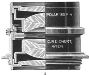
Abb. 24 a und b. Ansicht und Schnitt von Photoobjektiven. a Mikropolar von REICHERT. b Mikrotar 1 : 6,3 und f = 9 cm von ZEISS.
