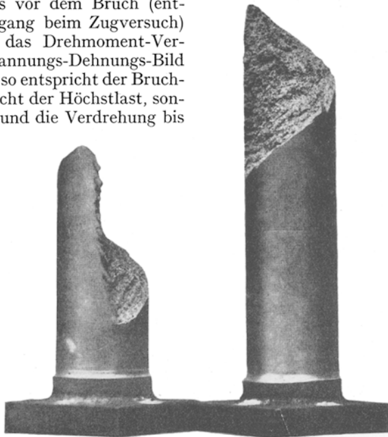
Abb. 93. Verdrehbruchfläche eines spröden Werkstoffes (Gußeisen) (SCHULZE-VOLLHARDT).
