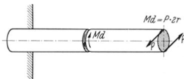
Abb. 89. Kräfte am eingespannten, verdrehten Stab.
