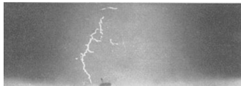
Abb. 8. Röntgenbild einer Bleibronze mit Spannungsriß.
