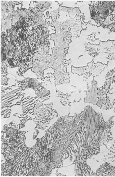
Abb. 99. Ferritkristalle in Perlit. Stahl mit 0,45% C langsam abgekühlt. V 600×.
