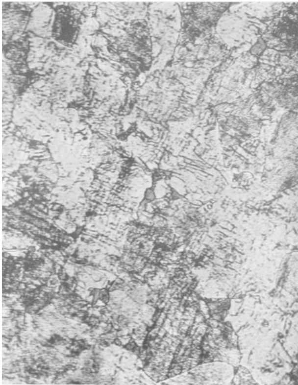
Abb. 20. Korrosion durch Ätzmittel in den Rutschebenen eines kaltverformten weichen Eisens. V 400 \times .
