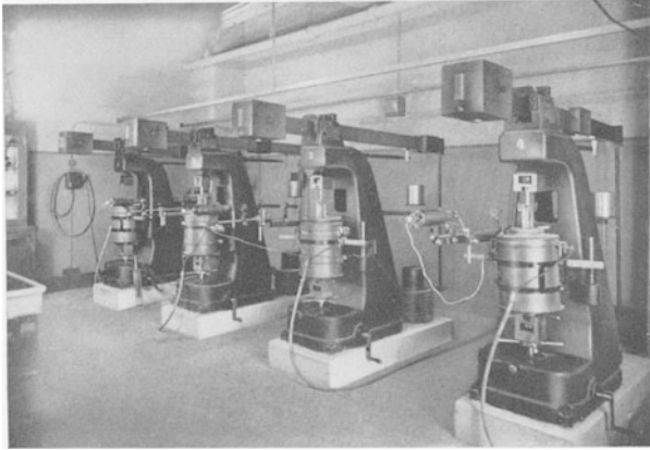
Abb 12. Teil der Dauerstandanlage des Kaiser-Wilhelm-Instituts für Eisenforschung. (Nach A. POMP und W. ENDERS.)
