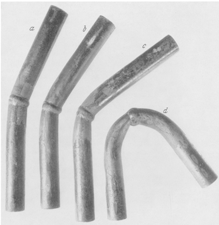
Abb. 56. Biegeproben von geschweißten Rohren. a bis c schlecht (Rißbildung auf der Zugseite), d gut.
