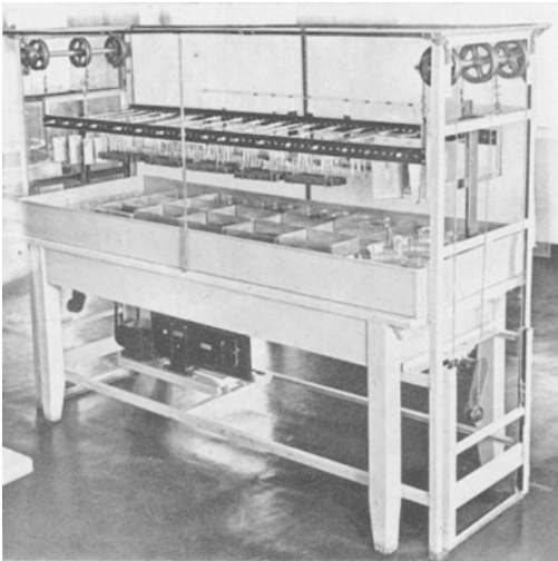
Abb. 29. Elektrisch gesteuertes Wechseltauchgerät für gleichzeitige Prüfung in verschiedenen Lösungen. Chem.-Techn. Reichsanstalt.
