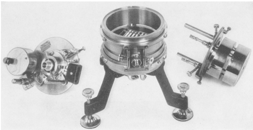
Abb. 57. Hochtemperaturkammer nach SEEMANN.
