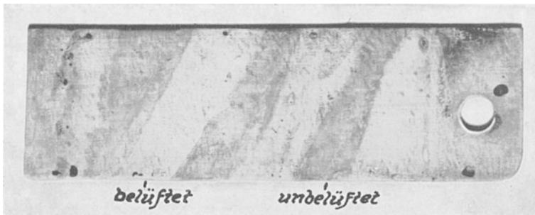
Abb. 24. Belüftungskorrosion. Rosten von Eisen unter einer Binde. (Nach BAISCH und WERNER.)
