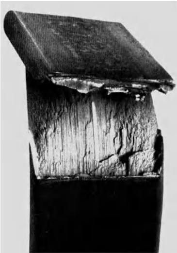
Abb. 32. Bruchaussehen eines Manganfederstahles.
