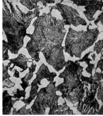
Abb. 3. Perlitgefüge mit Ferritkristallen. V = 200.
