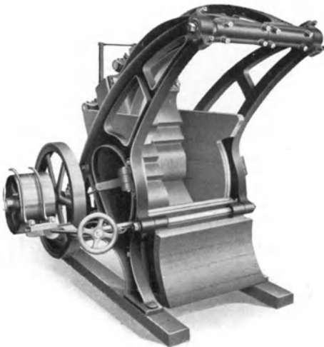
Abb. 77. Kurbel- oder Hammerwalke (Ernst Geßner A.-G., Aue i. Erzg.).
