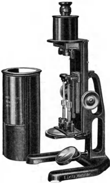
Abb. 150. Das Leitz-Colorimeter nach BÜRGER. (Hersteller: Firma E. Leitz, Wetzlar.) (Abbildung entnommen aus GEIGER-SCHEELS Handb. d. Physik, Bd. 20.)
