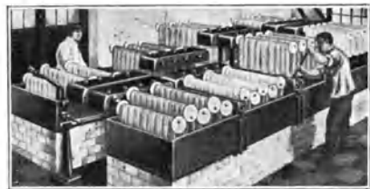
Abb. 155. Stranggarnfärbemaschine für Seide, Kunstseide u. a. m. (Gerber-Wansleben, Krefeld).
