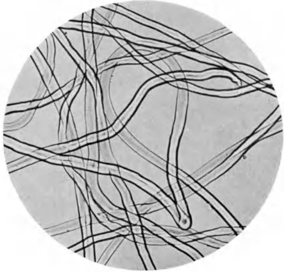
Abb. 250. Gut mercerisierfähige Baumwolle (nach dem Mercerisieren). Vergr. 150 (s. S. 590).
