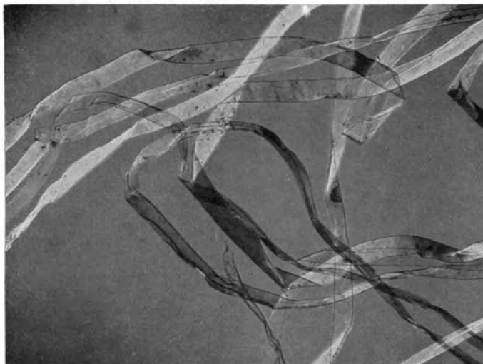
Abb. 245. Tote Baumwolle in polarisiertem Licht. Nicols gekreuzt, Glimmerplatte \frac{1}{8}\lambda . Vergr. 200 (s. S. 586).
