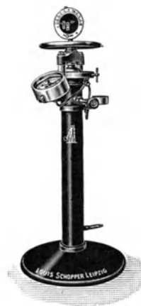
Abb. 333. Zerplatz- oder Berstapparat Schopper-Dalén.
