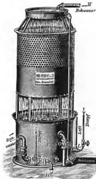
Abb. 353. Offene Enteisenung (Reisert).
