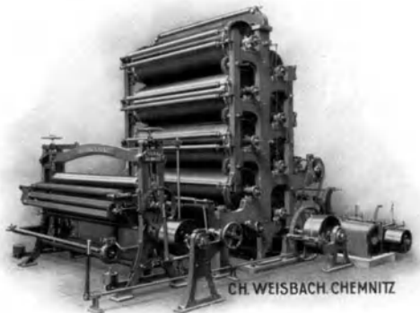
Abb. 57. Zylindertrockenmaschine für einseitige Warenanlage, stehende Anordnung mit Stärkmaschine (C. H. Weisbach, Chemnitz).
