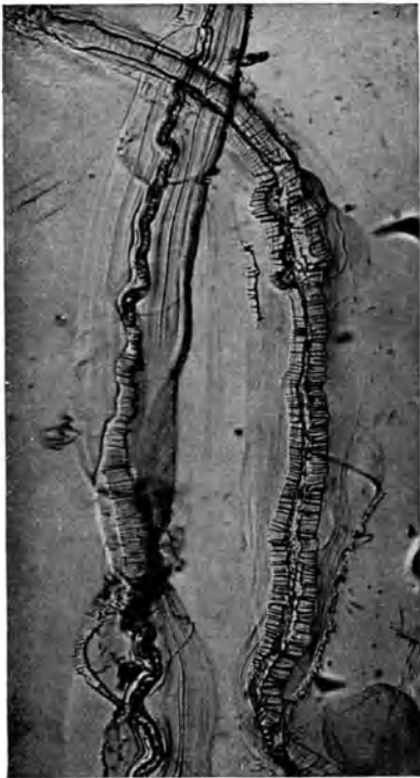
Abb. 260. Zwei ungebleichte Hanffasern in Kupferoxydammoniak. Vergr. 100 (s. S. 592).
