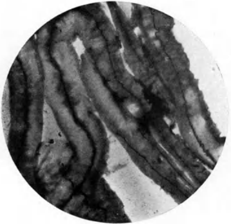
Abb. 257. Flachsfasern in Jod und Quellschwefelsäure. Vergr. 90 (s. S. 592).
