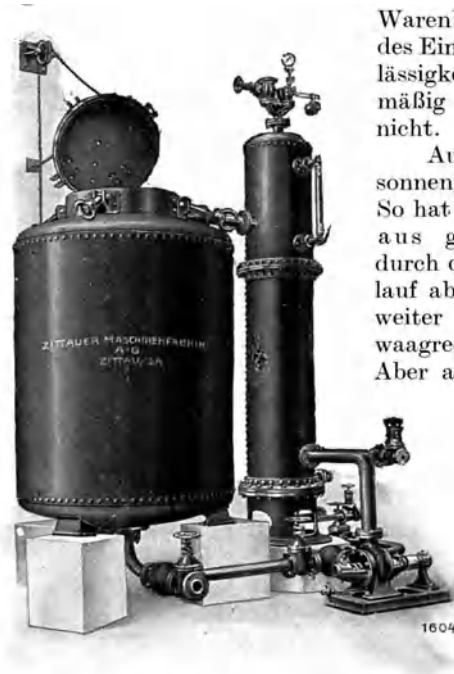
Abb. 92. Hochdruckkessel mit erhöhtem Vorwärmer und Zirkulationspumpe (Zittauer Maschinenfabrik A.-G., Zittau).
