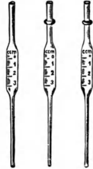
Abb. 342. Sauerstoffpipetten nach WINKLER (P. Altmann, Berlin).
