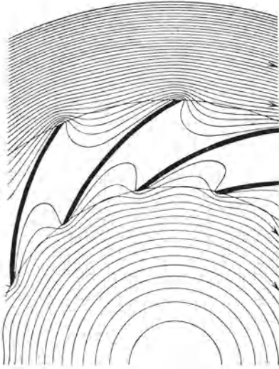
Abb. 79. Relative Verdrängungsströmung (Kanalwirbel ohne Zirkulation) 1 .
