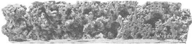
Abb. 165a. Durch Kavitation ausgenagte Gußoberfläche.
