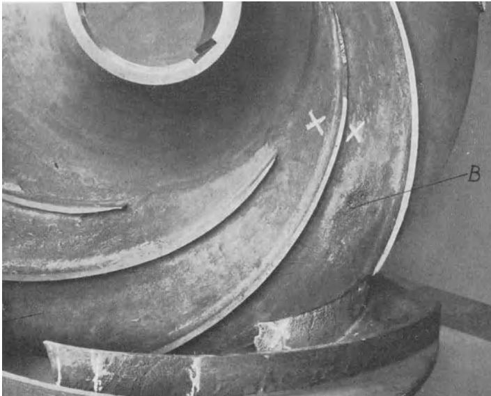
Abb. 177. Die beiden aufeinandergesetzten Hälften eines auseinandergeschnittenen Laufrades.
