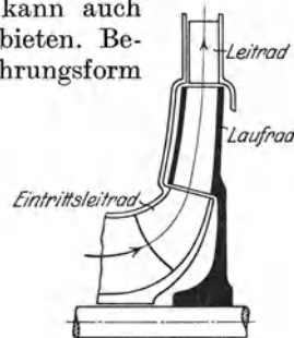
Abb. 4. Radialpumpe mit Leitrad am Ein- und Austritt.
