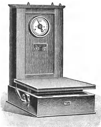
Abb. 48. Federwaage (Waage für Postpakete ohne angegebenen Wert). Stempel und Jahreszeichen auf dem Schilde.
