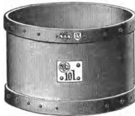
Abb. 25. Hohlmaß aus Metall. Durch Stempelung gesichertes Schild.
