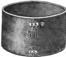
Abb. 23. Spanmaß ohne Beschlag. Stempelung über der Bezeichnung und am Boden.
