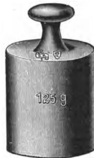
Abb. 35. Gewicht ohne Berichtigungskammer aus Messing in hoher Zylinderform mit Knopf.
