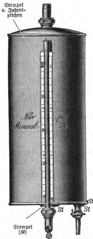
Abb. 20. Meßwerkzeug für Flüssigkeiten mit gleichartiger Einteilung für Mineralöl.
