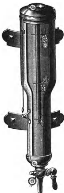
Abb. 19. Meßwerkzeug für Flüssigkeiten mit ungleichartiger Einteilung.
