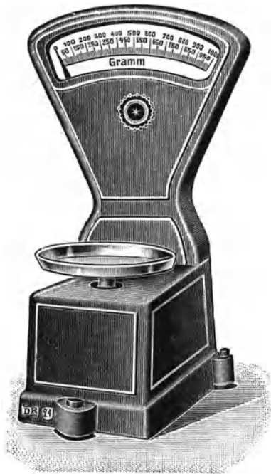
Abb. 43. Selbsttätige Neigungswaage. Stempel und Jahreszeichen auf der Grundplatte.
