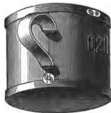
Abb. 14. Weichgelötetes Flüssigkeitsmaß. Stempel und Jahreszeichen über der Bezeichnung am oberen Rande und Stempel auf der Lötnaht.
