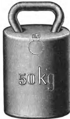
Abb. 33. Gewicht mit Ver- richtigungskammer aus Gusseisen.
