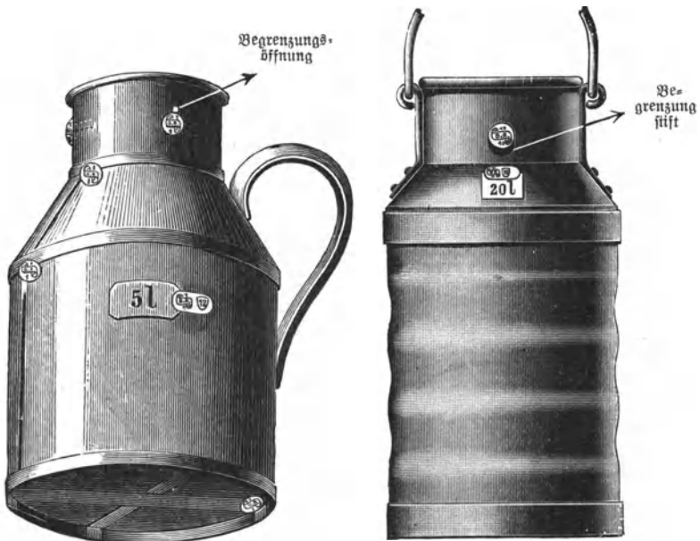
Abb. 15. Kannenförmiges Flüssigkeitsmaß, weich gelötet. Bezeichnung auf besonderem Schilde, durch Stempel und Jahreszeichen gesichert. Stempel unter den Begrenzungsmarken und auf den Lötnahten.
