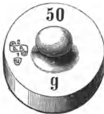
Abb. 34. Gewicht ohne Berichtigungskammer aus Messing mit Knopf.
