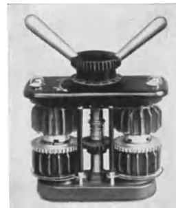
Abb. 14. Regulierbare Doppelfunkenstrecke mit Indikatorlampen (Siemens-Reiniger-Veifa).
