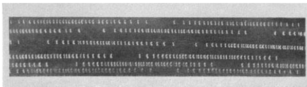
Abb. 12. Aufnahme der Funkenfolge im Patientenkreis eines Diathermieapparates (Siemens-Reiniger-Veifa).
