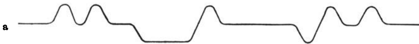
Fig. 473. Wellenschrift durch hin und her gehende transversale Bewegung eines Schreibstiftes auf einem sich bewegenden Papierstreifen.
