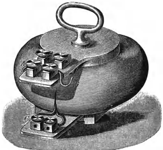
Fig. 105. Älterer Transformator von Ganz & Co.; Manteltypus.
