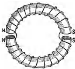
Fig. 329. Der Grammesche Ring als Doppelmagnet.
