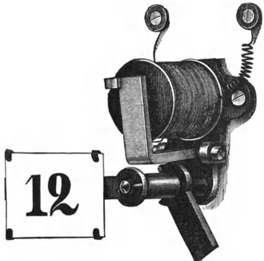
Fig. 563. Der Mechanismus der Fallklappe; gelöst.
