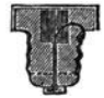
Fig. 231 c. Verbindung der beiden Kontakt- stücke des Stöß- fels durch den Bleistreifen.
