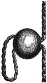
Fig. 202. Vorrichtung zum beliebigen Verkürzen der Aufhängeschnur.
