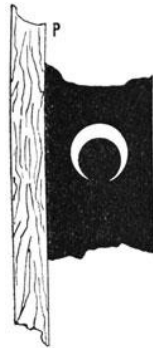
Fig. 647. Rollende Bewegung der Kohlenwalze in den Zapflöchern.
