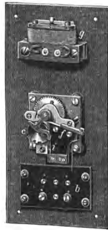
Fig. 590. Mechanismus des Zeitsichen Feuermelders.
