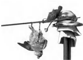
Abb. 62. Erdschlußstörung (Isolatorenüberschlag, Leitungsriß) hervorgerufen durch Vögel.
