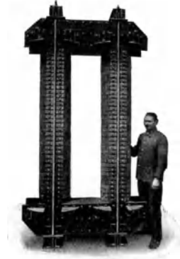
Abb. 191. Eisenkern einer Petersen-Spule für 6300 kVA, 110 kV Netzspannung.
