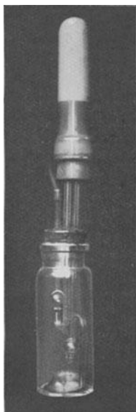
Abb. 20. Verdunstungsmesser mit Rückfußsicherung nach LIVINGSTON und SHIVE.
