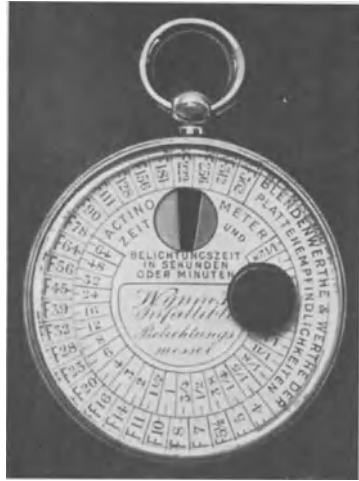
Abb. 16. Photometer von WYNNE.
