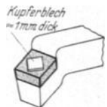
Abb. 42. Kupferblech als Lötmittel.
