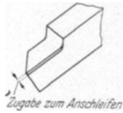
Abb. 37. Schaft geschmiedet mit Schleifzugabe.
