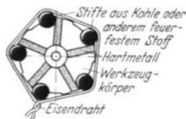
Abb. 51. Drahtzusammengehaltener Senker zum Löten.
