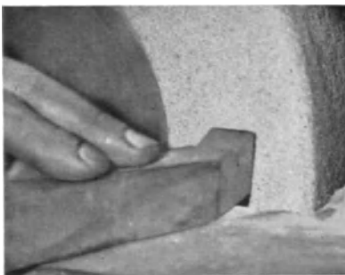
Abb. 53. Vorschliff auf mittelkörniger Scheibe. (Gebr. Böhler.)
