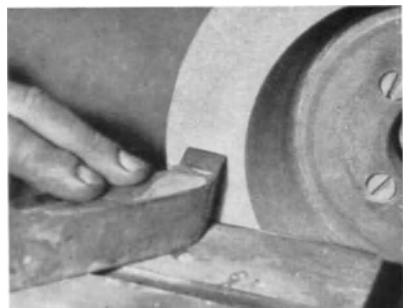
Abb. 54. Nachschliff auf feinkörniger Scheibe. (Gebr. Böhler.)
