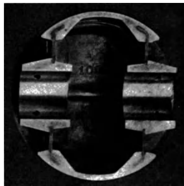
Abb. 126. Kolben eines Automobilzylinders, aus Silizium-Aluminium mit eingegossener Scheibe aus Invarstahl. Aus dem oben genannten Nickelhandbuch.
