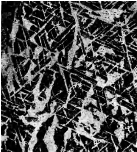
Abb. 206 a. Schliffbild vor dem Glühen. Vergrößerung = 95, HNO 3 . Man erkennt deutlich die Nadelstruktur. Aus dem Versuchslaboratorium des Kriegerwerks in Düsseldorf-Oberkassel.
