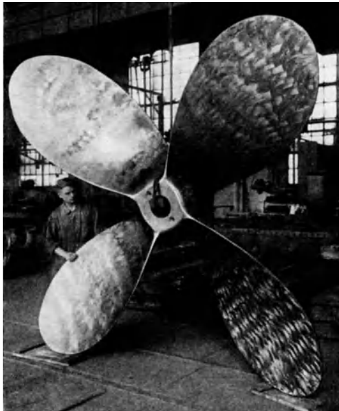
Abb. 133. Schiffspropeller aus V 2 A-Stahlguß. Krupp.
