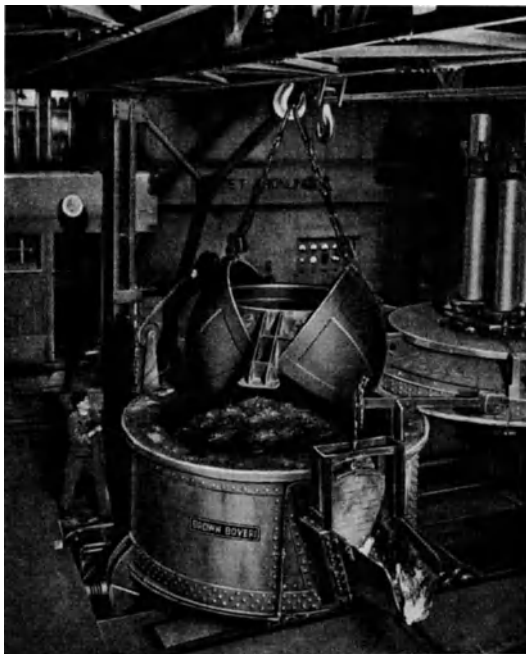
Abb. 72. Stahlschmelzofen von Brown-Boveri in Mannheim, 7,3 t, elektrisch-hydraulischer Elektrodenregulierung, hydraulische Kipp- und Türbetätigungsverrichtungen. Die Beschickung erfolgt mit einem Kübel, der Bodenentleerung hat.
