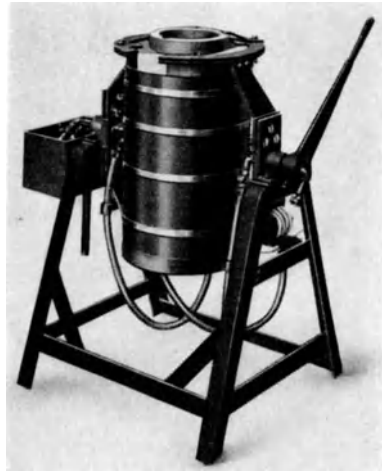
Abb. 86. Kleiner Hochfrequenzinduktionsofen von Siemens u. Halske. Der Ofen wird mit der Hand gekippt (vgl. auch Abb. 91).
