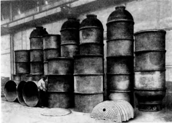
Abb. 118. Kolonnenteile aus säurebeständigem Thermosilidguß. Krupp.
