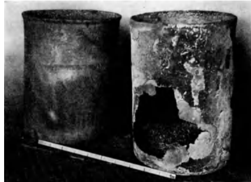
Abb. 130. Links: Glühtopf aus NCT-Stahl, nach 203 Glühungen. Rechts: Glühtopf aus unlegiertem Stahlguß, nach 8 Glühungen. Krupp.
