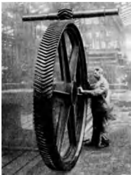
Abb. 114. Zahnrad aus Si-Stahlguß. Krupp.
