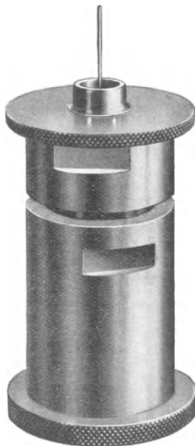
Abb. 94. Einfacher Emanationsapparat der Auergesellschaft „Radonator“.
