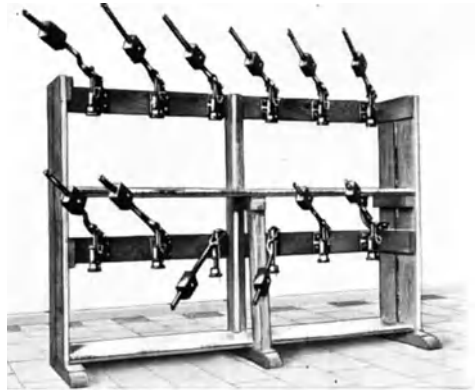
Abb. 7. Einfache (Wand-) Hebelpresse in zwei Reihen angeordnet
