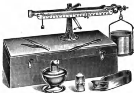
Abb. 1. Superiorwaage von GERBER zur Butterwasserbestimmung
