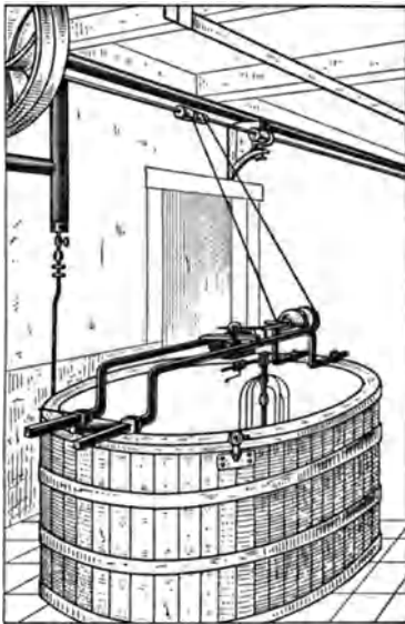
Abb. 3. Rührwerk der Dampfkäserei-anlage H. Vogt-Gut A. G., Arbon in der Schweiz
