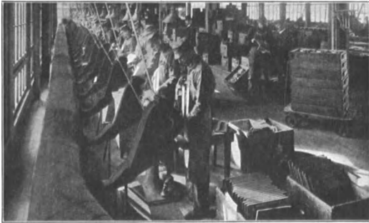
Fig. 45. Staubabsaugung in einem Schleifsaal der Nat.-Reg.-Kass.-Gesellschaft.
