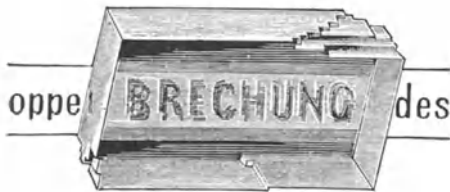
Abb. 436. Doppelbrechung im Kalkspat.
