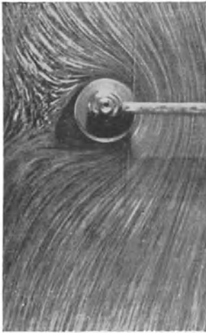
Abb. 110. Strömung um einen rotierenden Zylinder. (Nach PRANDTL.)
