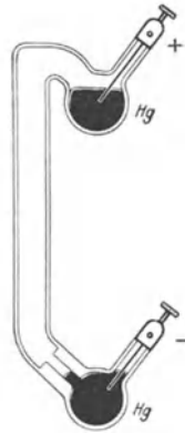
Abb. 250. Quecksilberlampe aus Glas. (Aus POHL, Elektrizitätslehre.)
