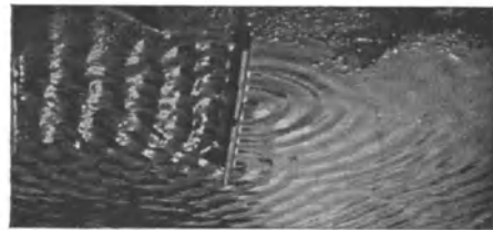
Abb. 139. Beugung einer Wasserwelle an einem Loch nach GRIMSEHL.
