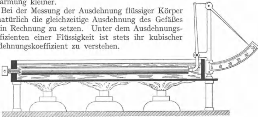
Abb. 154. Längenänderung eines Stabes durch die Wärme.
