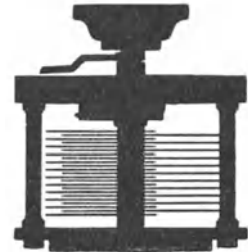
Abb. 200. Drehkondensator. (Aus Poni, Elektrizitätslehre.)
