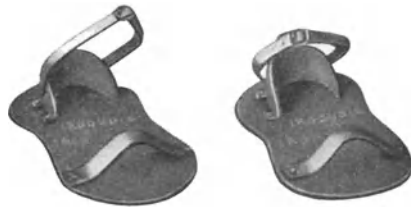
Sandalen für Arbeiter bei Walzasphaltarbeiten.
