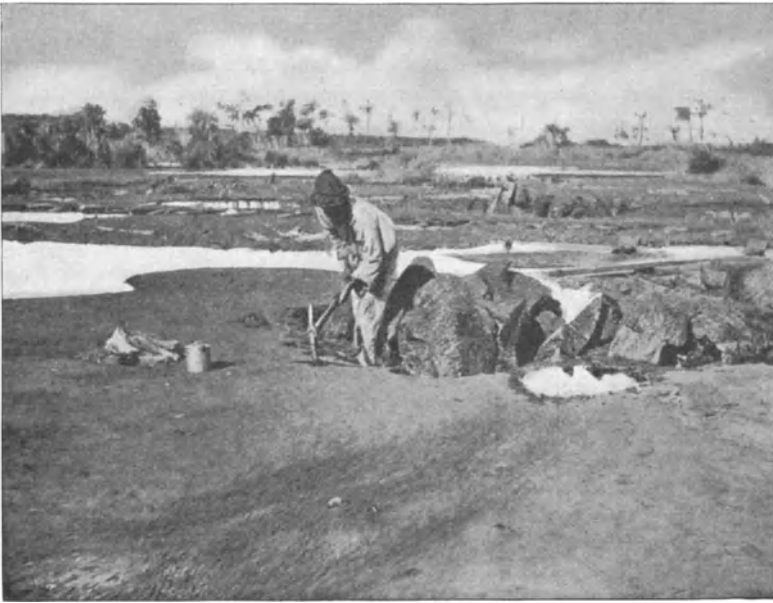
Das Aufhacken des festen Asphalts.
