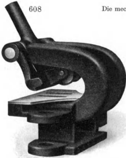
Abb. 147b. Tasterkluppe für besonders feine oder stark appretierte Waren. Sie ist mit Röllchentaster ausgestattet und mit oberem Finger versehen, der zum zentralen Öffnen der Kluppenklappe durch eine rotierende Tellerscheibe dient.
