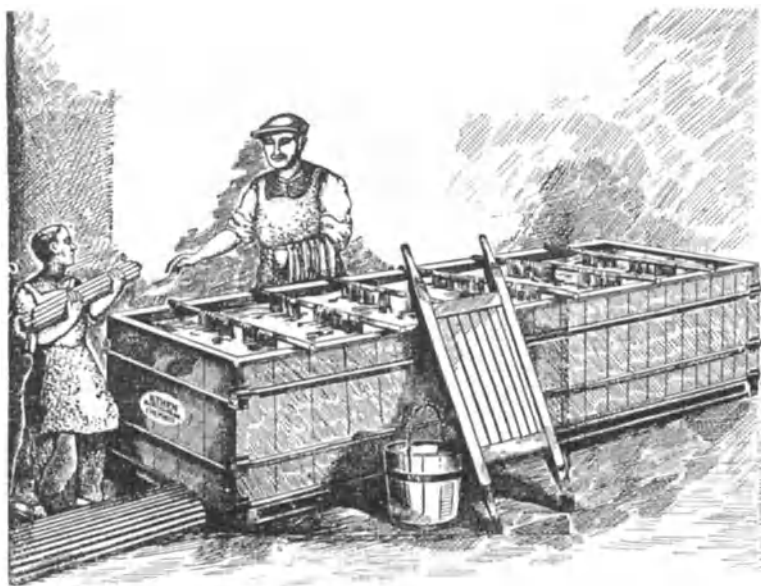
Abb. 72. Färbebottich für Strähngarn-Handfärberei; R. Then, Chemnitz.
