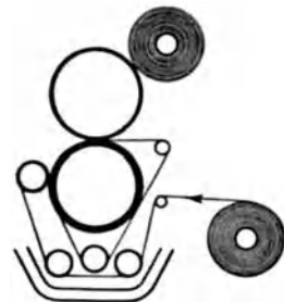
Abb. 47. Warengang beim hydraulischen Foulard; Zittauer Maschinenfabrik A. G. Zittau.
