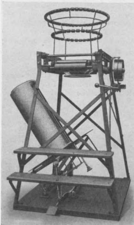
Abb. 264. Automatische Umkehrvorrichtung für Rundgewirke; Maschinenfabrik Arbach G. m. b. H., Reutlingen i. W.
