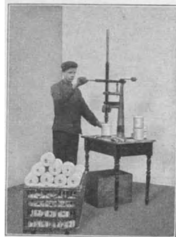
Abb. 84. Hülseneinstößvorrichtung für das Färben von Kreuz- und Sonnenspulen; Textilmaschinenfabrik B. Cohnen G. m. b. H., Grevenbroich b. Köln
