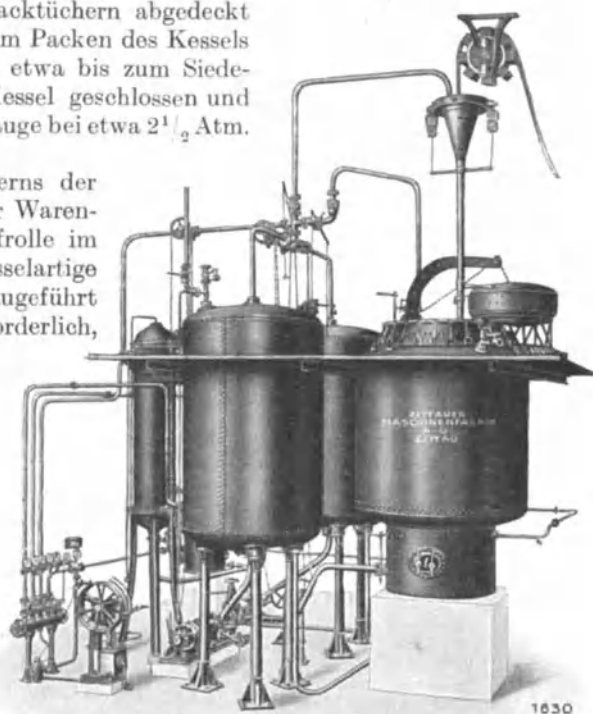
Abb. 27. Bäckkesselanlage (Mathesius-Freiberger-Thies); Zittauer Maschinenfabrik A.-G., Zittau.
