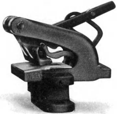
Abb. 147c. Tasterkluppe mit hinterer nochmaliger Führung, Schleiftaster mit Entlastungsbügel sowie beweglicher Greiffläche am Hebel, so daß jede Warenstärke mit voller Sicherheit und bei größter Schonung gehalten werden kann.
