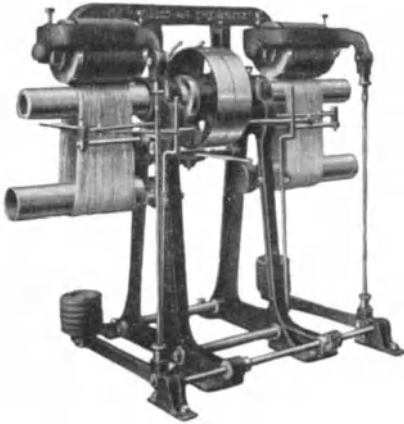
Abb. 235. Zweiseitige Zweiwalzen-Garmangel; C. G. Haubold A.-G., Chemnitz.
