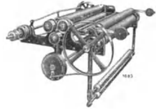
Abb. 260. Strangöffner; Zittauer Maschinenfabrik A.-G., Zittau.
