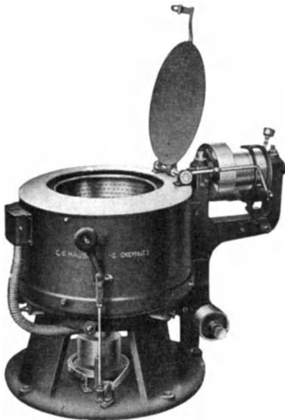
Abb. 128. Zentrifuge mit Unterantrieb durch ein am Zentrifugenmantel befestigtes Vorgelege und Sicherheitsdeckelverschluß; C. G. Haubold A.-G., Chemnitz.
