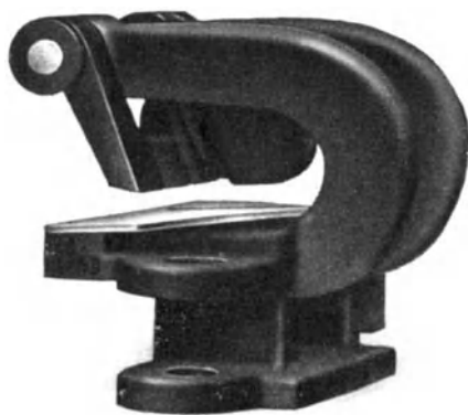
Abb. 147a. Tasterkluppe für horizontalen Kettenlauf, findet Verwendung bei Breitstreck- und Egalisiermaschinen sowie den als Planrahmen bekannten Spann- und Trockenmaschinen.
