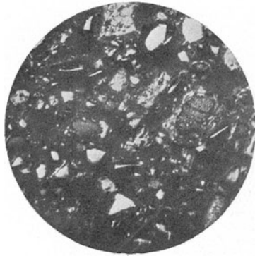
Abb. 17. Reinkohlearstellung, Verunreinigung einer Gaskohle durch Eisenspat (Dichtestufe + 1,35 der Siebstufe — 0,06 mm) (Vergr. 208 fach, trocken)
