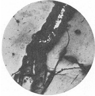
Abb. 3. Schwefelkies und Kalkspateinlagerungen im Vitrit auf Schwundrissen und Schlechten (Vergr. 84fach, trocken)
