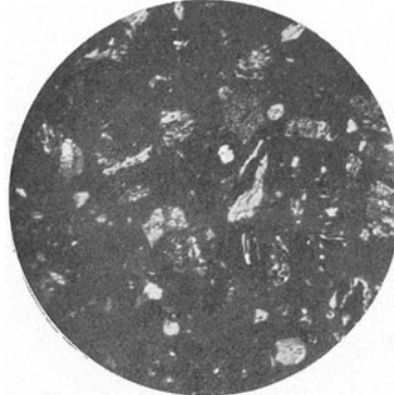
Abb. 18. Reinkohlearstellung, Verunreinigung einer Fettkohle durch Tonsubstanz (Dichtestufe + 1,6 der Siebstufe — 0,06 mm) (Vergr. 208 fach, trocken)
