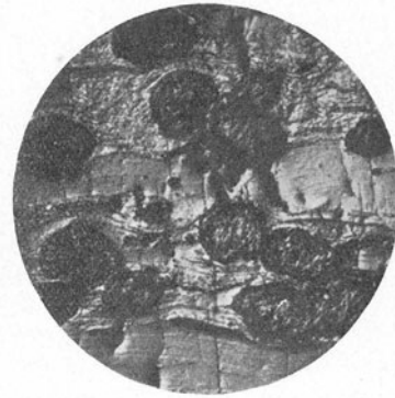
Abb. 5. Eisenspatkonkretionen, Flöz Röttgersbank (Vergr. 17fach, trocken)
