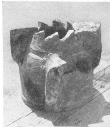
Abb. 4. Fertig aufgeschweißte Bohrkronen
