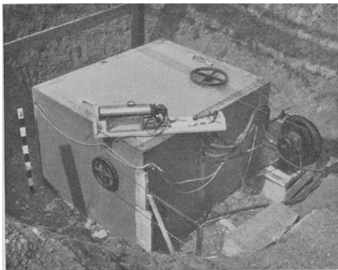
Abb. 2. Die Explosionskiste geschlossen mit darauf befindlichem Interferometer
