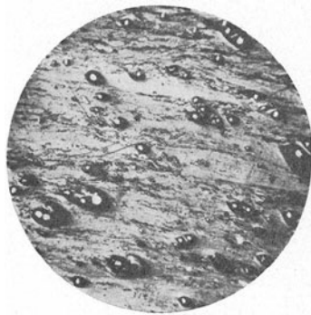
Abb. 9. Pyritimprägnierter Brandschiefer, Flöz Albert (Vergr. 92fach, Ölimmersion)
