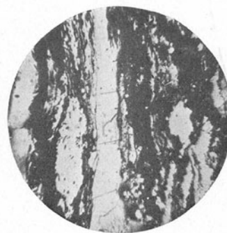
Abb. 10. Brandschiefer mit mittelstarker Aschenführung, Flöz Mathilde III (Vergr. 92fach, Ölimmersion)
