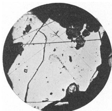
Abb. 11. Eisenspateneinsprengung in Magerkohlenvitrit (Vergr. 54fach, trocken)
