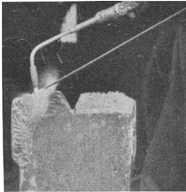
Abb. 3. Auftragsarbeit an einem Fischschwanzbohrer
