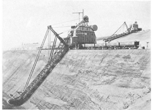
Abb. 2. 2 Abraamtiefbagger von 800 und 500 l Eimerinhalt
